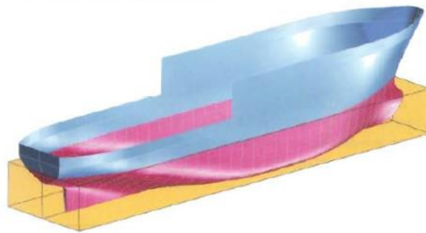
Slika 21. Grafički prikaz blok koeficijenta [17]
