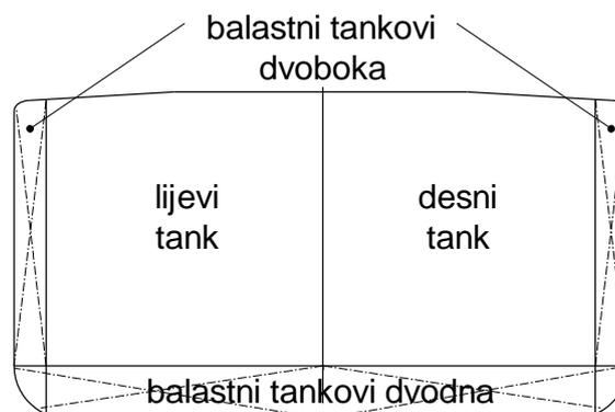
Slika 17. Tanker s dvostrukom oplatom i jednom uzdužnom pregradom
