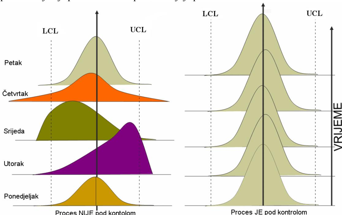
Slika 5.3: Dovodenje procesa "pod kontrolu"
