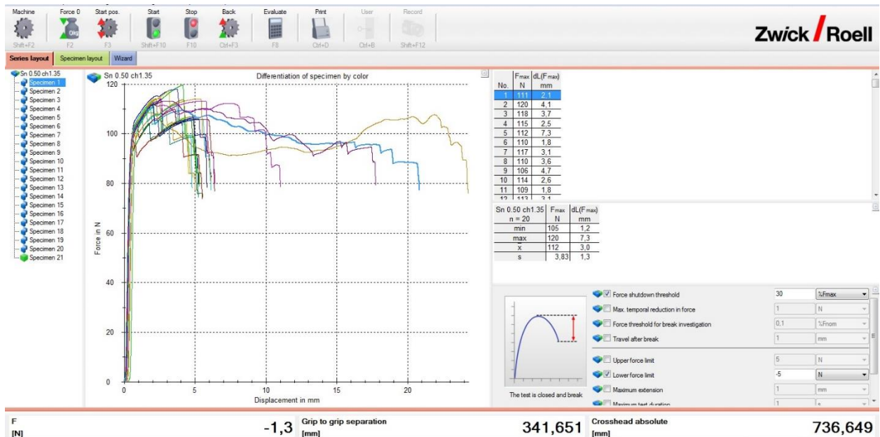
Dijagram sila-produljenje za 0,50 mm 2 žicu, 1,35 mm visina steznog spoja, prevlaka kositra
