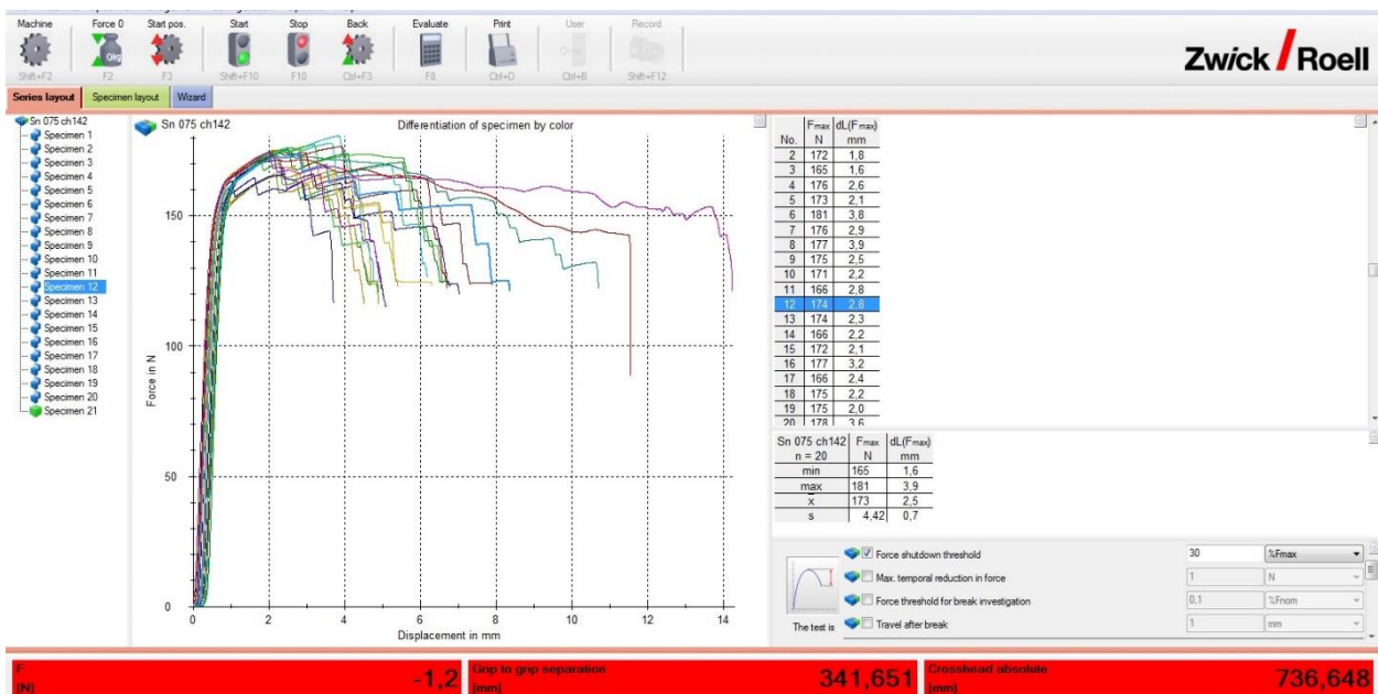
Dijagram sila-produljenje za 0,75 mm 2 žicu, 1,43 mm visina steznog spoja, prevlaka kositra
