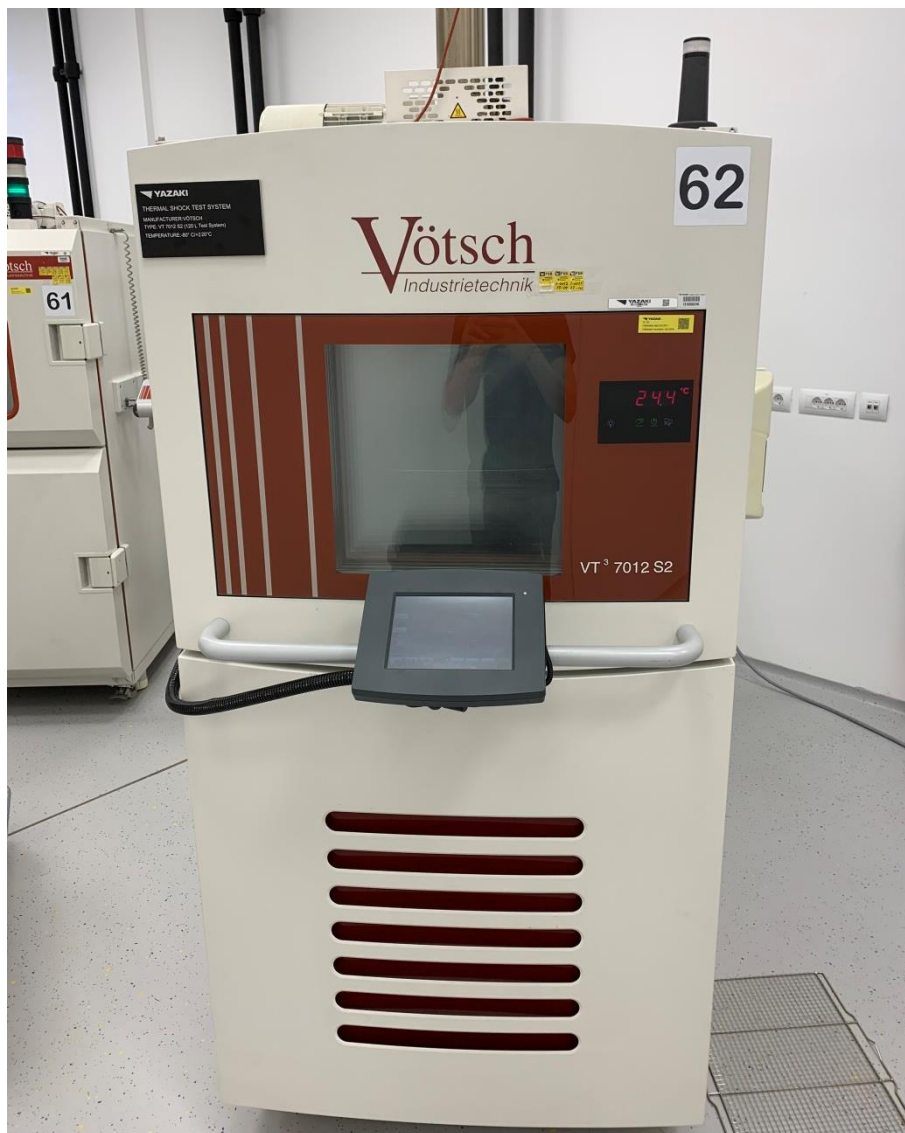
Slika 62. Vötsch VT 3 7012 S2 komora
