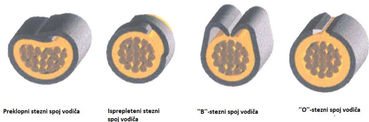
Slika 33. Oblici izolacijskog steznog spoja vodiča [18]
