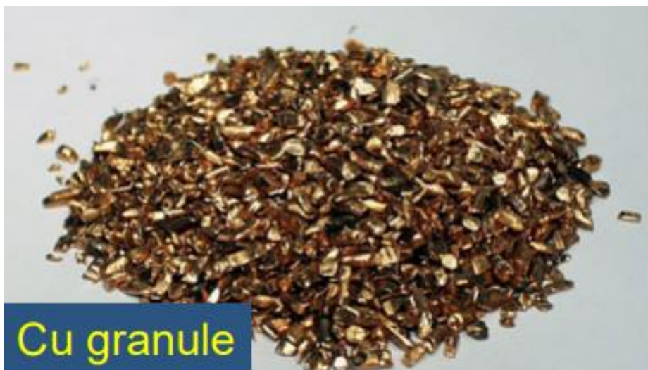
Slika 10. Bakrene granule nakon procesa recikliranja kabela [11]
