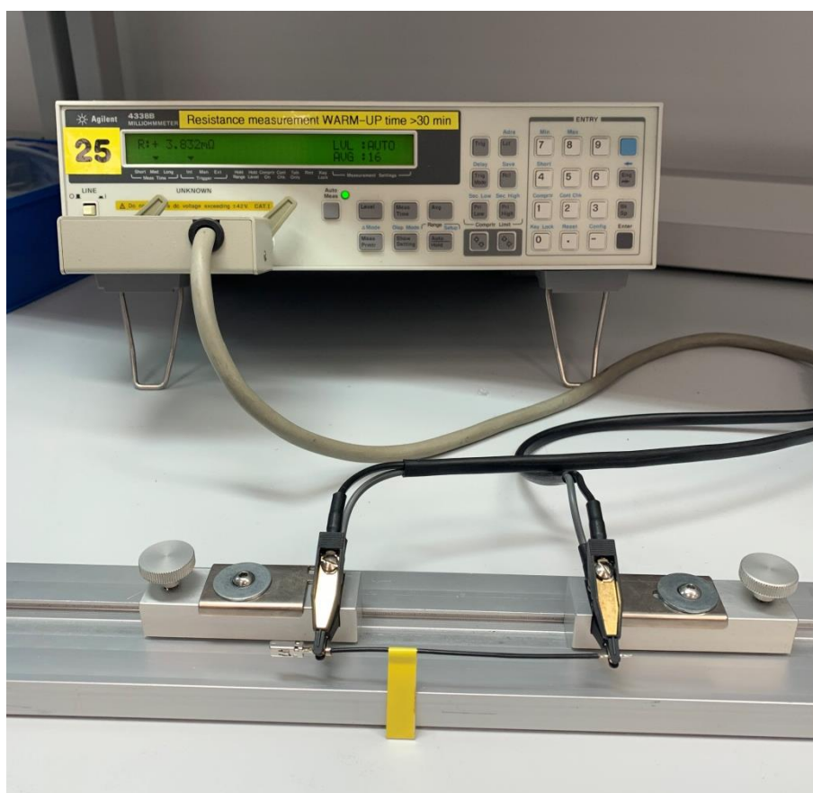
Slika 61. Uređaj Agilent 4338B miliommetar
