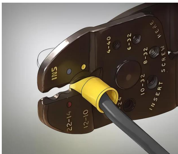
Slika 23. Stezno spajanje terminala i kabela ručnim alatom [26]
