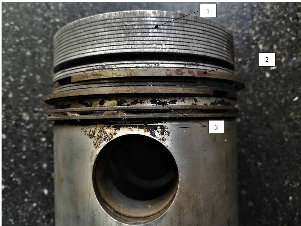
Slika 55. Tijelo klipa s označenim mehanizmima trošenja
