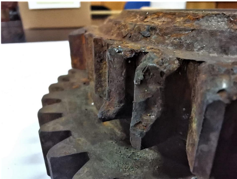
Slika 64. Površina loma zubi zupčanika
