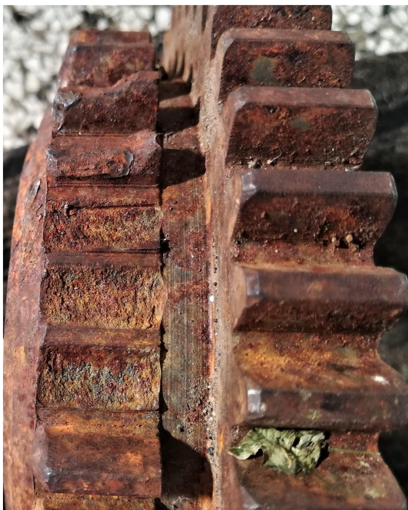
Slika 63. Površina loma zubi zupčanika
