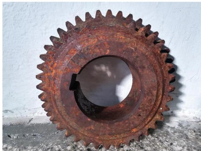
**Slika 26. Zupčanik mjenjača traktora Zetor 5211**
