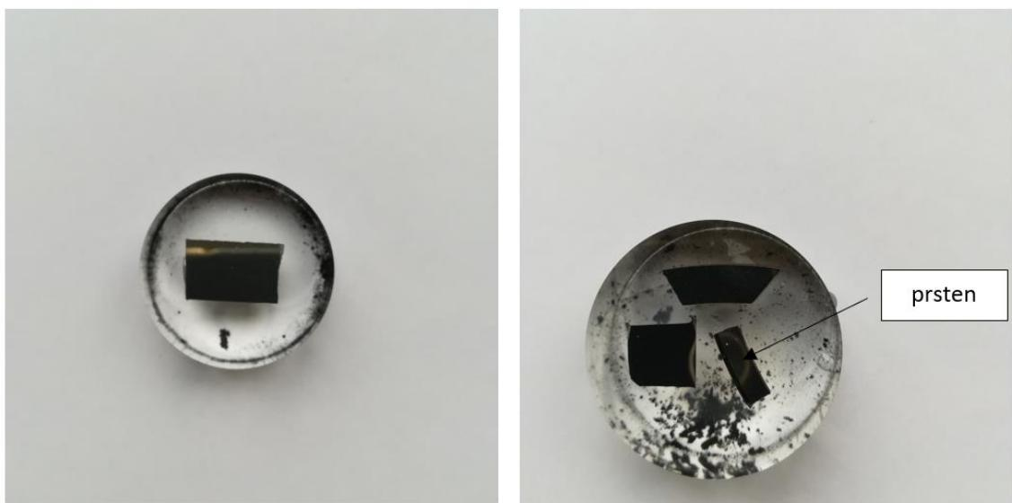
**Slika 35. Izgled uzorka nakon poliranja**
