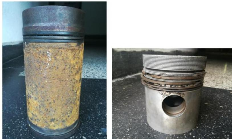
**Slika 25. Klip i košuljica cilindra traktora Zetor 4911**
