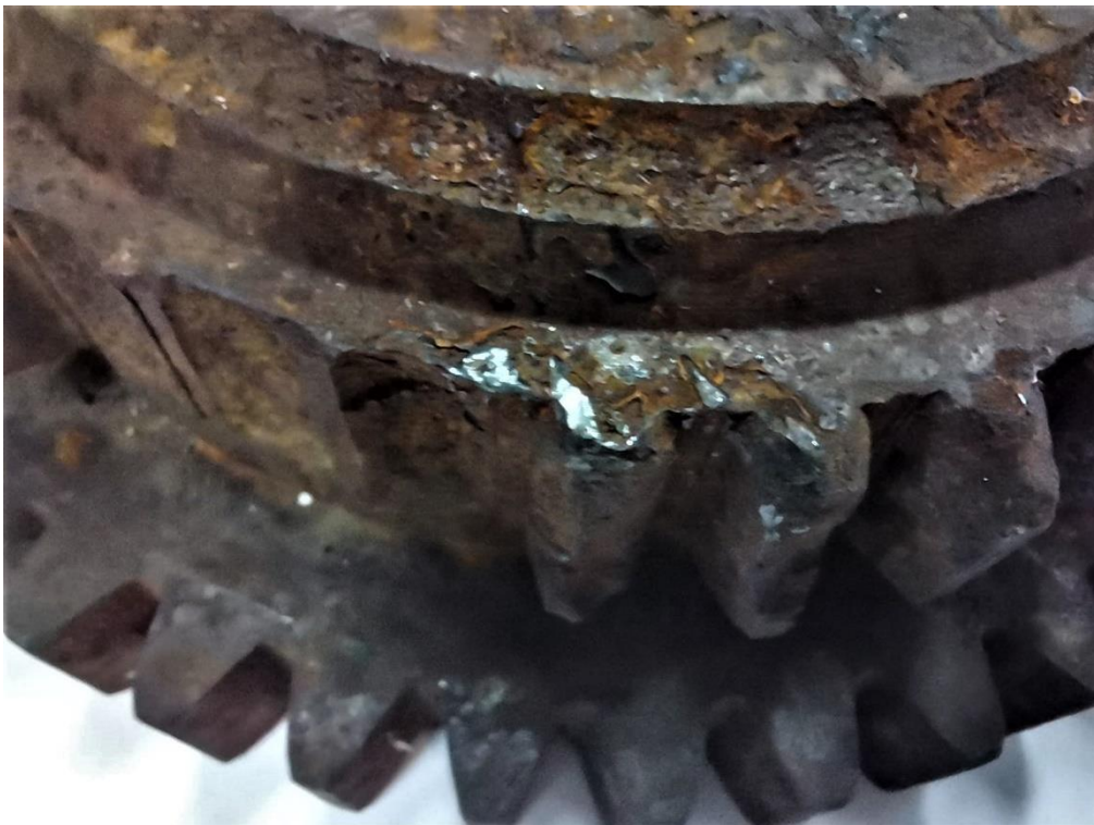
Slika 65. Prikaz korijena pukotine uslijed umora površine
