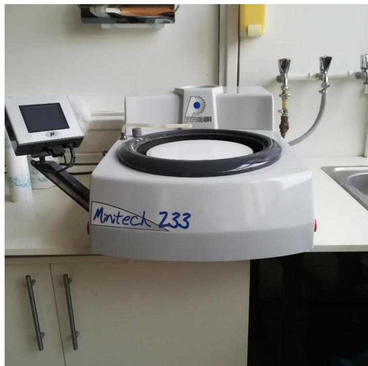
Slika 33. Uređaj za brušenje uzorka
