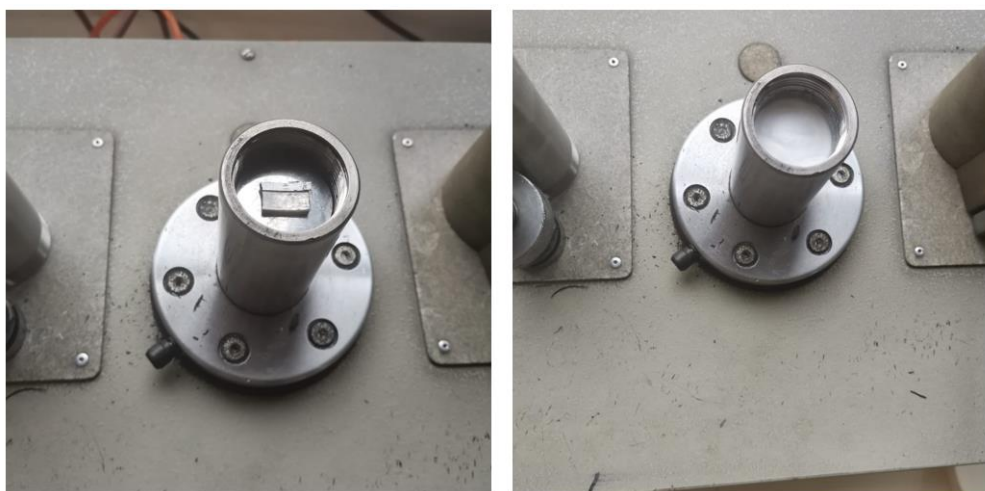
Slika 30. Postupak oblaganja uzorka prstena u polimernu masu
