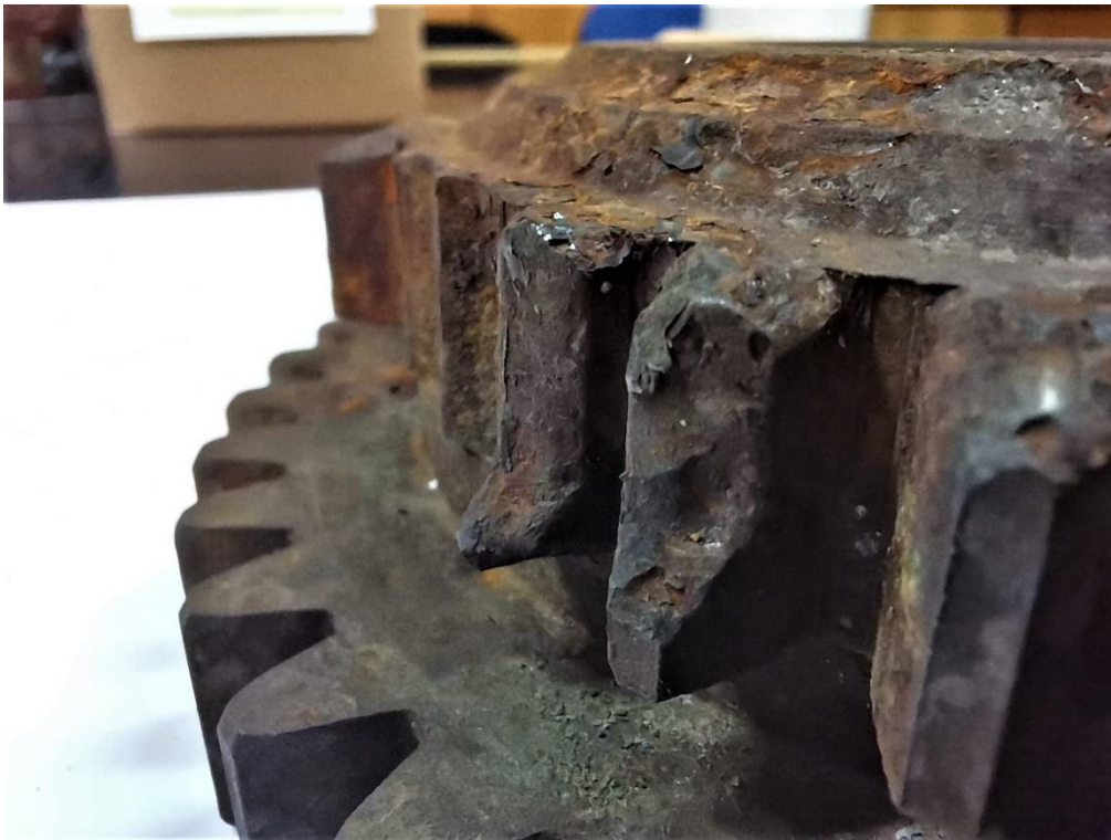
Slika 64. Površina loma zubi zupčanika
