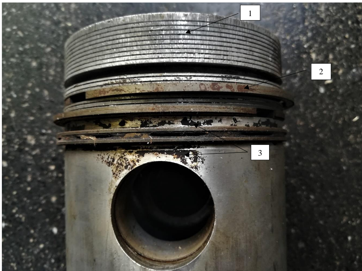
Slika 55. Tijelo klipa s označenim mehanizmima trošenja
