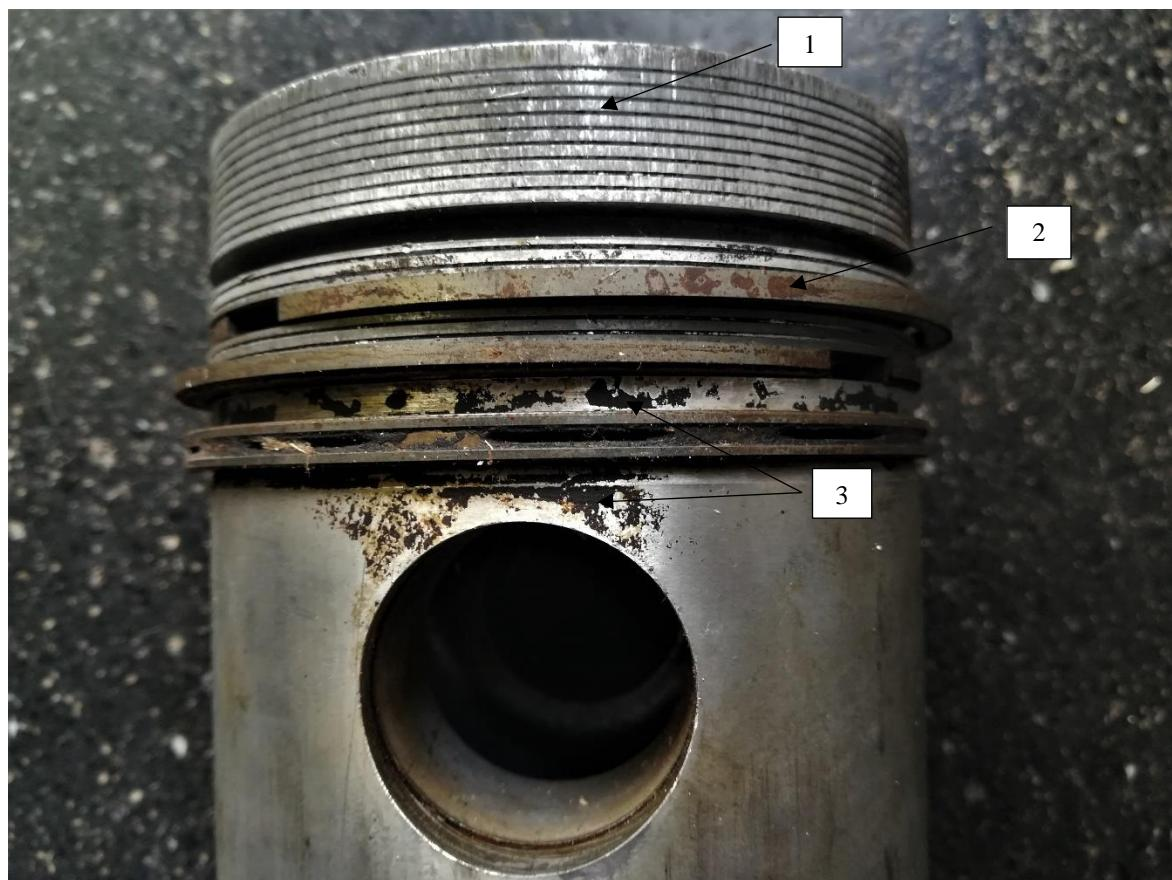
Slika 55. Tijelo klipa s označenim mehanizmima trošenja
