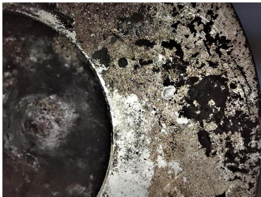
Slika 54. Pojava rupica na površini uslijed erozijskog djelovanja
