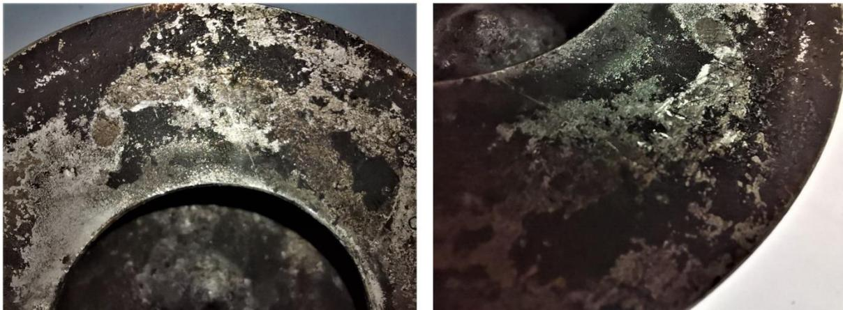
**Slika 53. Abrazijsko trošenje čela klipa**
