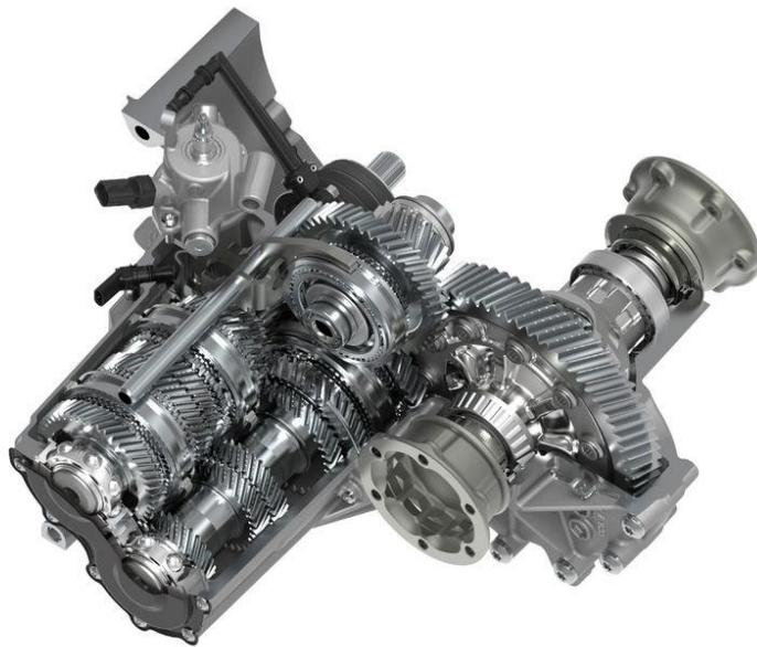
**Slika 5. Volkswagen-ov manualni mjenjač brzina [14]**
