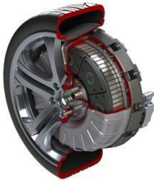
Slika 34. Elektromotor unutar kotača [81]
