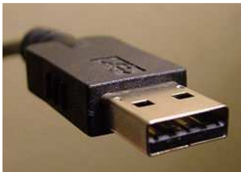
Slika 4.1. Standardni USB utikač
