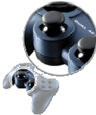
Slika 4.2. Analogni dio upravljačkog igračkog kontrolera
