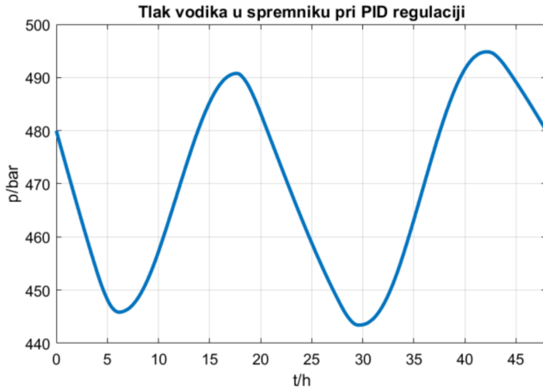
Slika 40. PID regulacija tlaka vodika u spremniku
