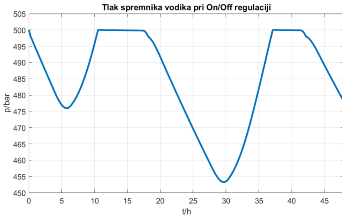
Slika 43. Tlak spremnika pri "On-Off" regulaciji
