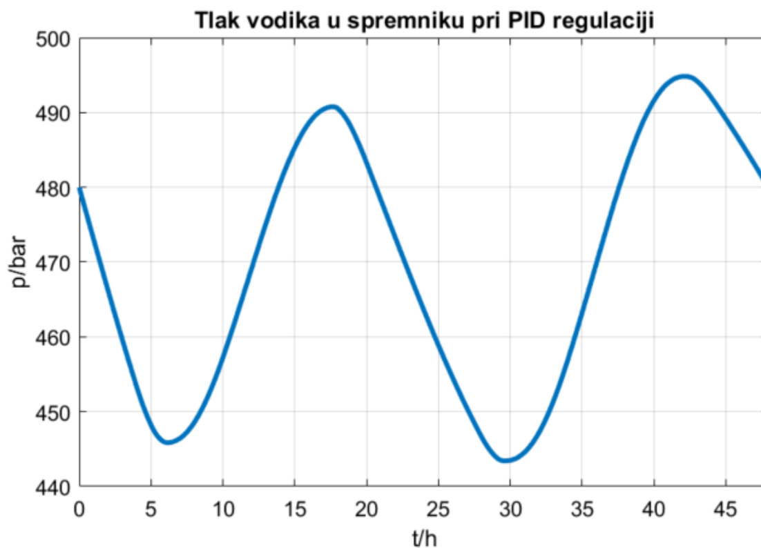
Slika 40. PID regulacija tlaka vodika u spremniku
