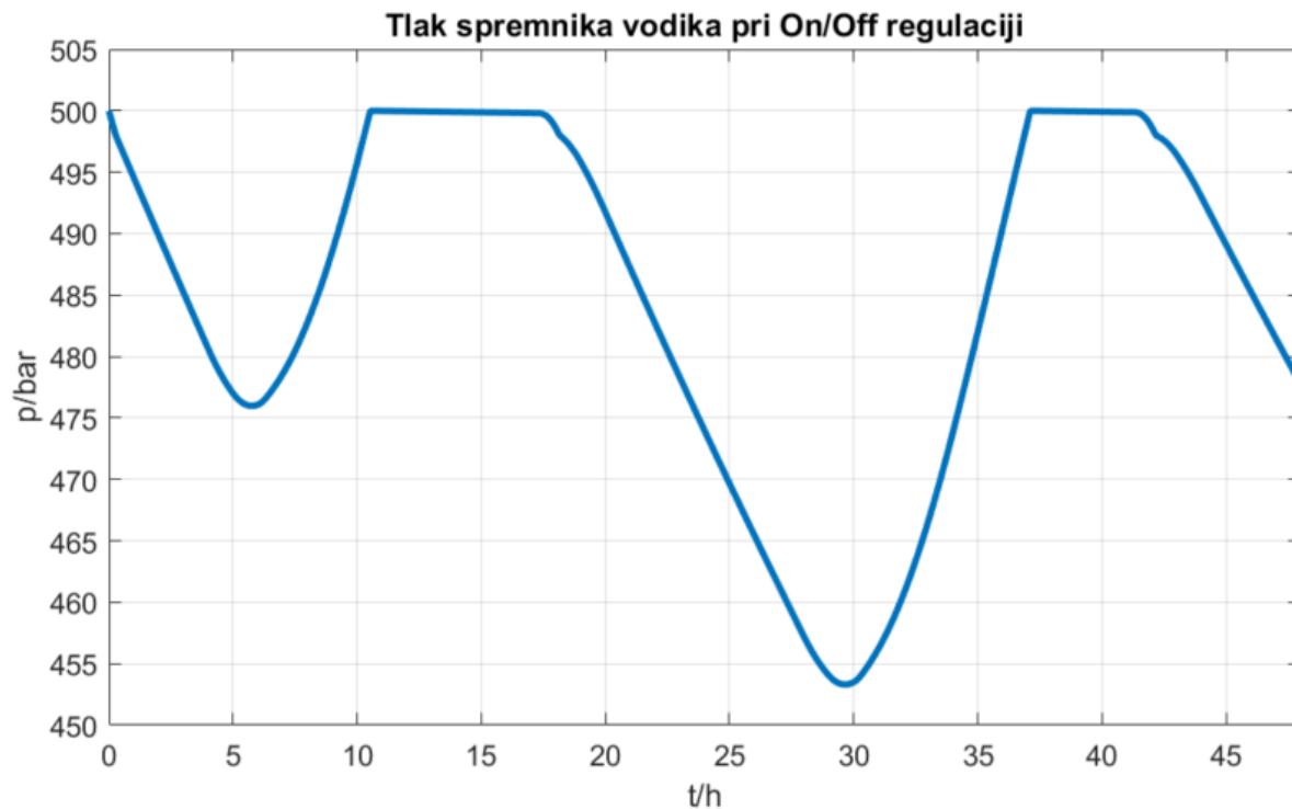
Slika 43. Tlak spremnika pri "On-Off" regulaciji
