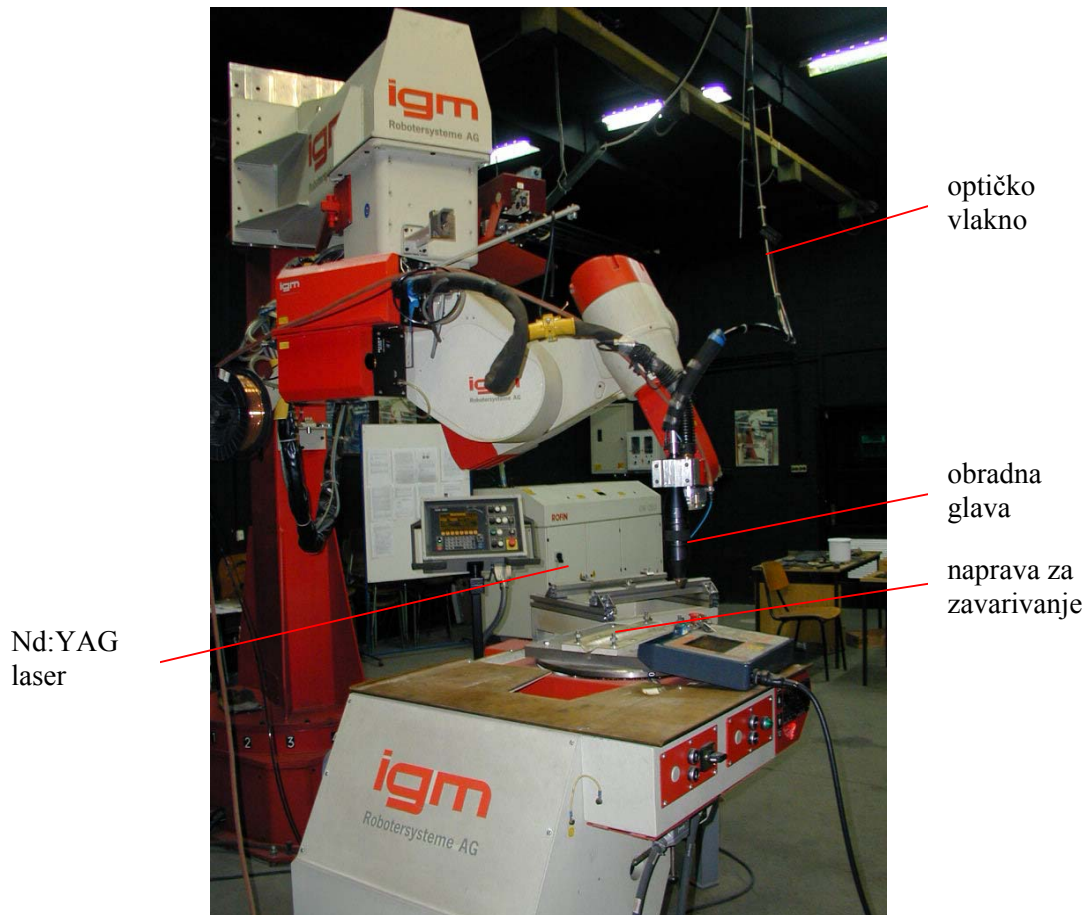
Slika 22. Sustav laser-robot, smješten u Laboratoriju za zavarivanje na FSB-u, Zagreb.
