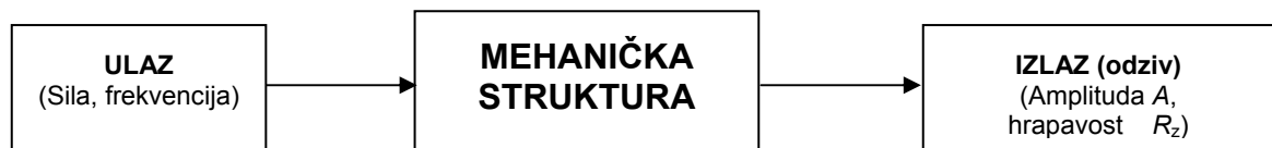
Slika 1.1. Svojstva samouzbudnih vibracija pri obradi odvajanjem čestica
