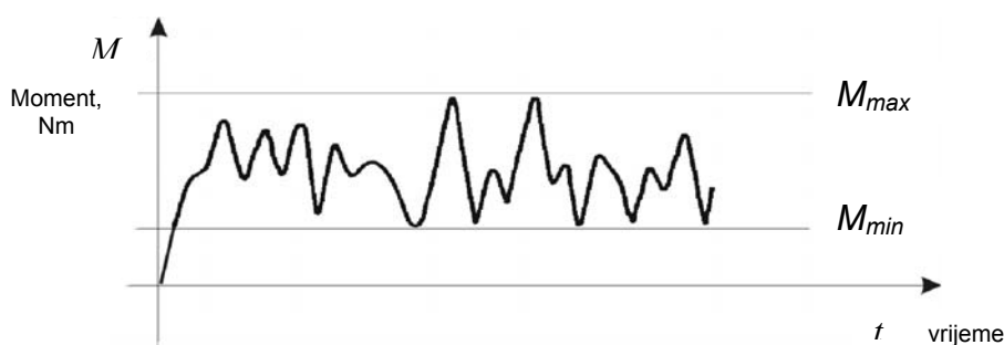
Slika 2.11. Dijagram promjene momenta
