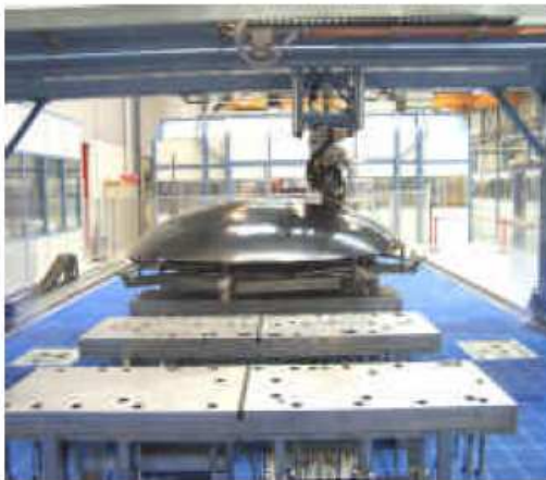
Slika 36: Airbus-ov višepretvornički PA uređaj i D-prikaz [7]
