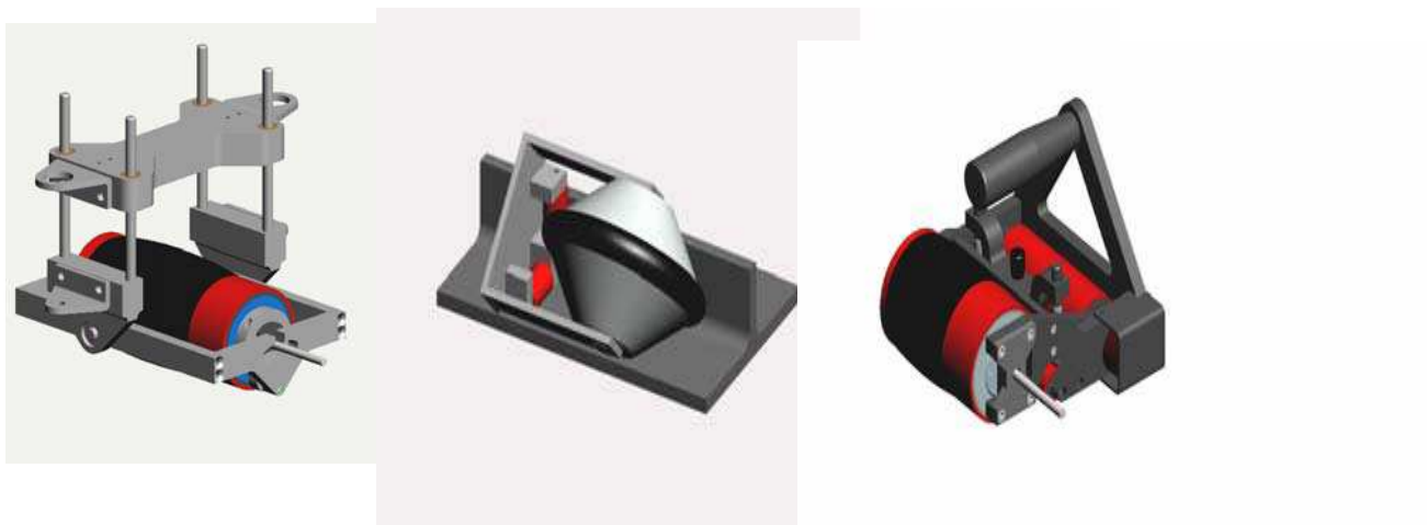
Slika 27: Prilagođene pokretne sonde razvijene za primjene u zrakoplovstvu [6]
