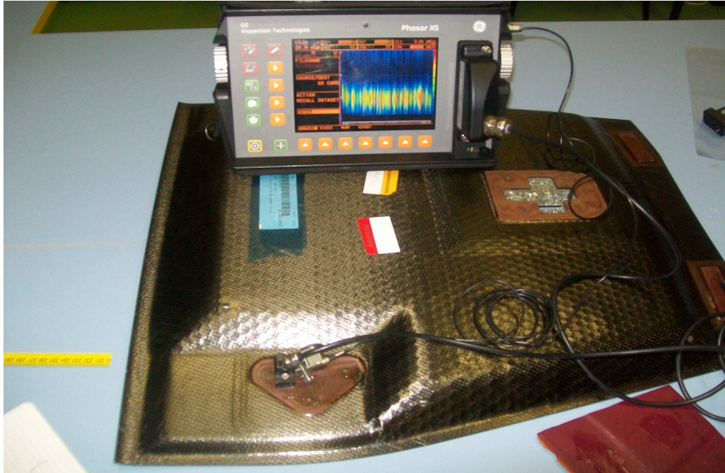
Slika 40: Ispitivanje s enkoderom i stvaranje B-prikaza
