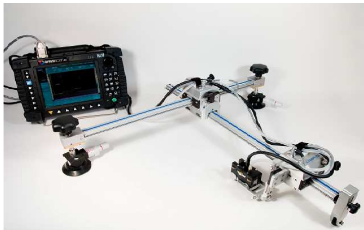
Slika 20: PA uređaj za ispitivanje kompozita [5]
