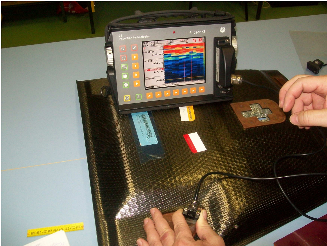
Slika 41: Linearno ispitivanje i stvaranje linearnog B-prikaza
