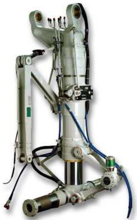
Slika 18: Cilindar stajnog trapa i stajni trap zrakoplova koji jedan je od primjera gdje se koristi višepretvornička ultrazvučna metoda ispitivanja [3]
