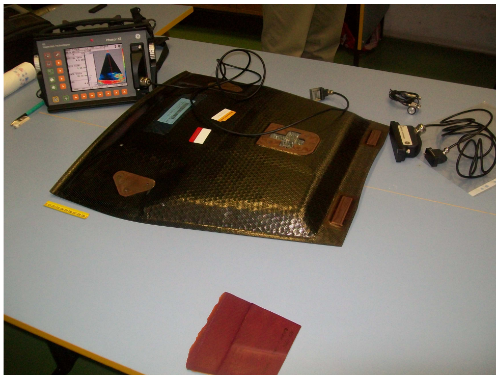
Slika 38: PA oprema i ispitivani uzorci od kompozita
