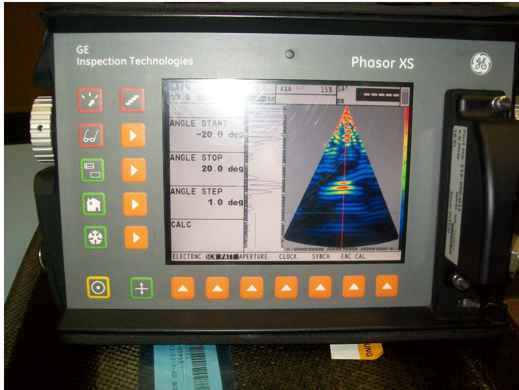
Slika 39: PA uređaj za ispitivanje i odgovarajući A-prikaz i S-prikaz
