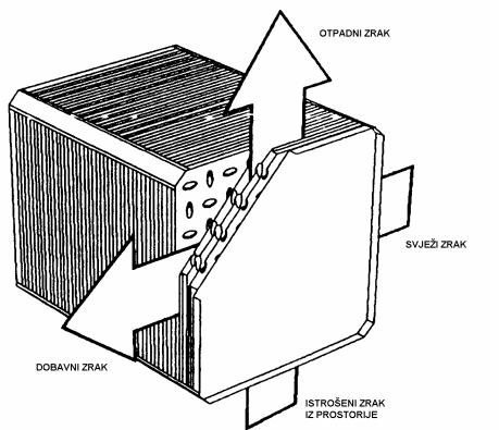
Slika 3.1 Sustav povrata topline s pločastim izmenjivačem
