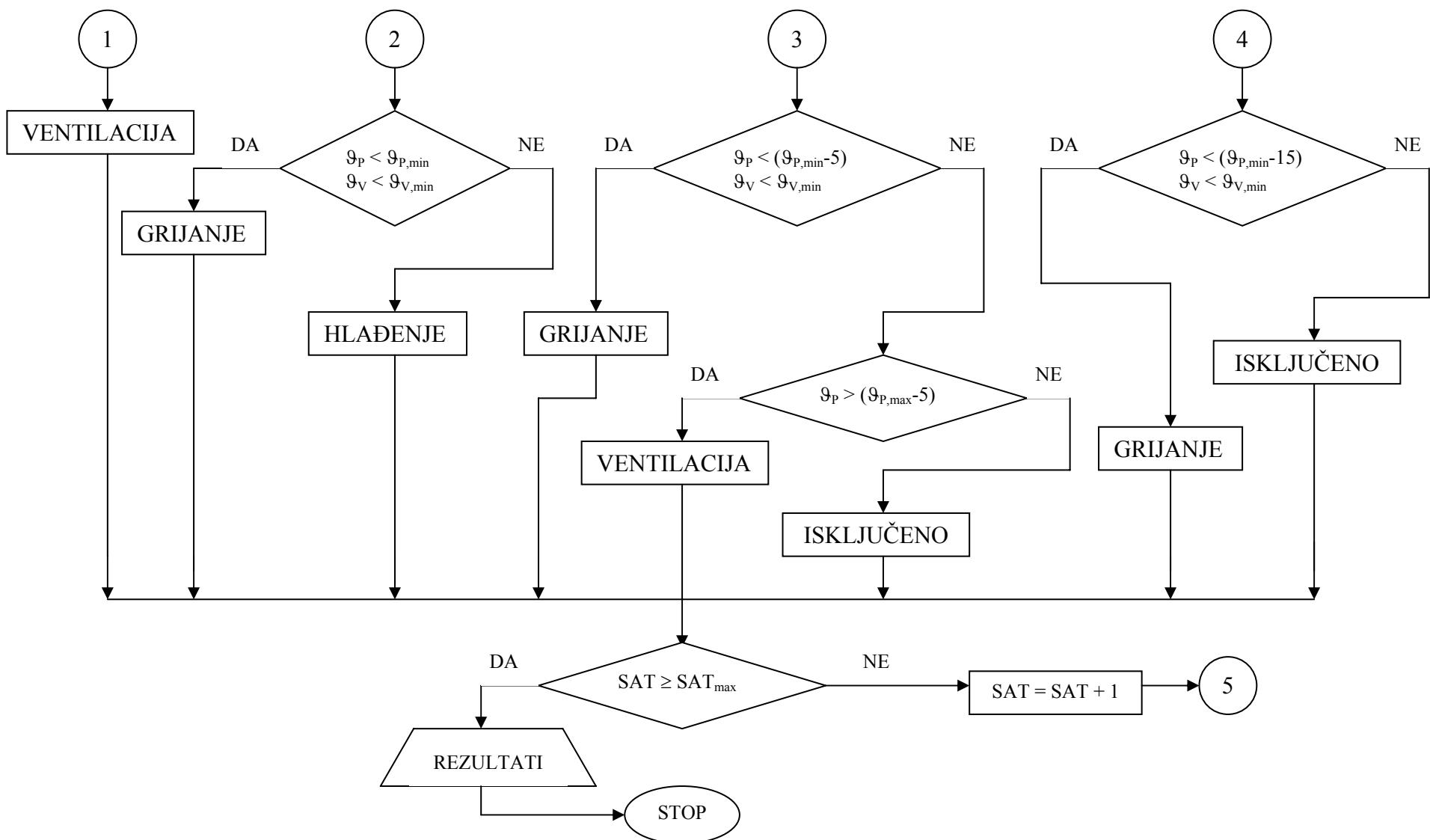
Slika 4.12 Pojednostavljeni opći dijagram toka glavnog programa
