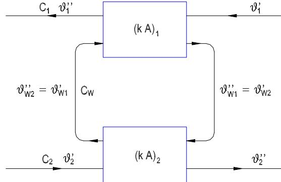
Slika 3.5 Shema sustava s dva izmjenjivača povezana cirkulacijskim vodom
