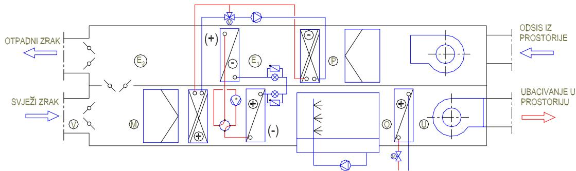
Slika 4.10 Klima komora s dizalicom topline i povezanim sustavom kružnog toka
