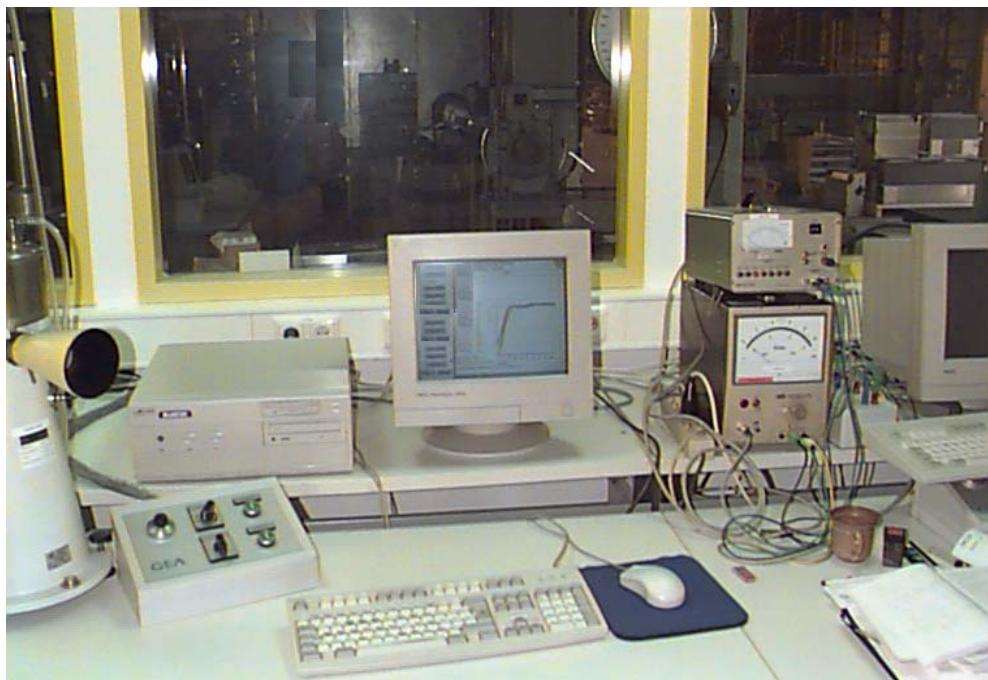
Slika 5.3 Prikaz mjernih instrumenata za mjerjenje i regulaciju protočnog volumena zraka
