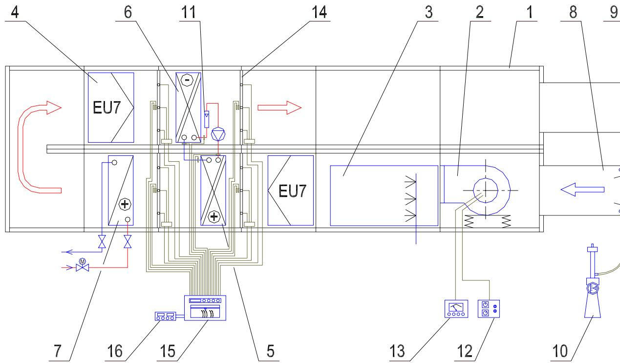
Slika 5.4 Shema mjerne linije – 1-klima jedinica; 2-ventilator; 3-ovlaživač; 4-filtar; 5-prvi izmjenjivač s.p.e.;
