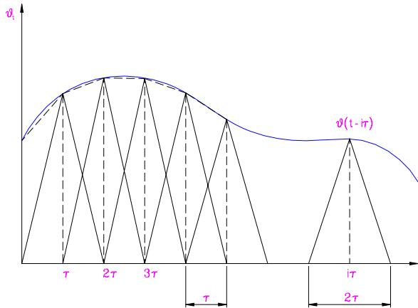
Slika 4.1 Trapezni pulsevi s prikazom zamjene trokutnim pulsevima
