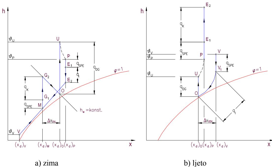
Slika 4.11 Karakteristični procesi pripreme zraka u klima komori s dizalicom topline i povezanim sustavom kružnog toka za zimsko i ljjetno razdoblje
