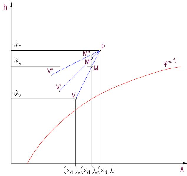
Slika 4.4 Ventilacija prostorije uz održavanje sadržaja vlage u zraku promjenom omjera miješanja svježe i optočne struje zraka
