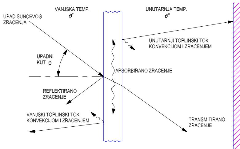
Slika 2.2 Toplinski tokovi uslijed sunčevog zračenja na staklenu površinu
