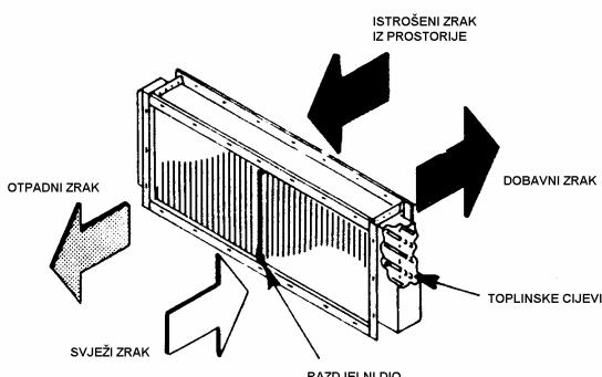
Slika 3.2 Sustav povrata topline s Heat Pipes izmjenjivačem
