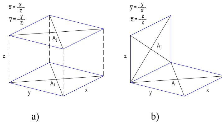
Slika 2.4 Prikaz geometrije a) paralelnih pravokutnika
