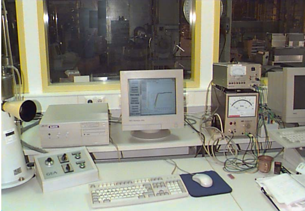
Slika 5.3 Prikaz mjernih instrumenata za mjerenje i regulaciju protočnog volumena zraka
