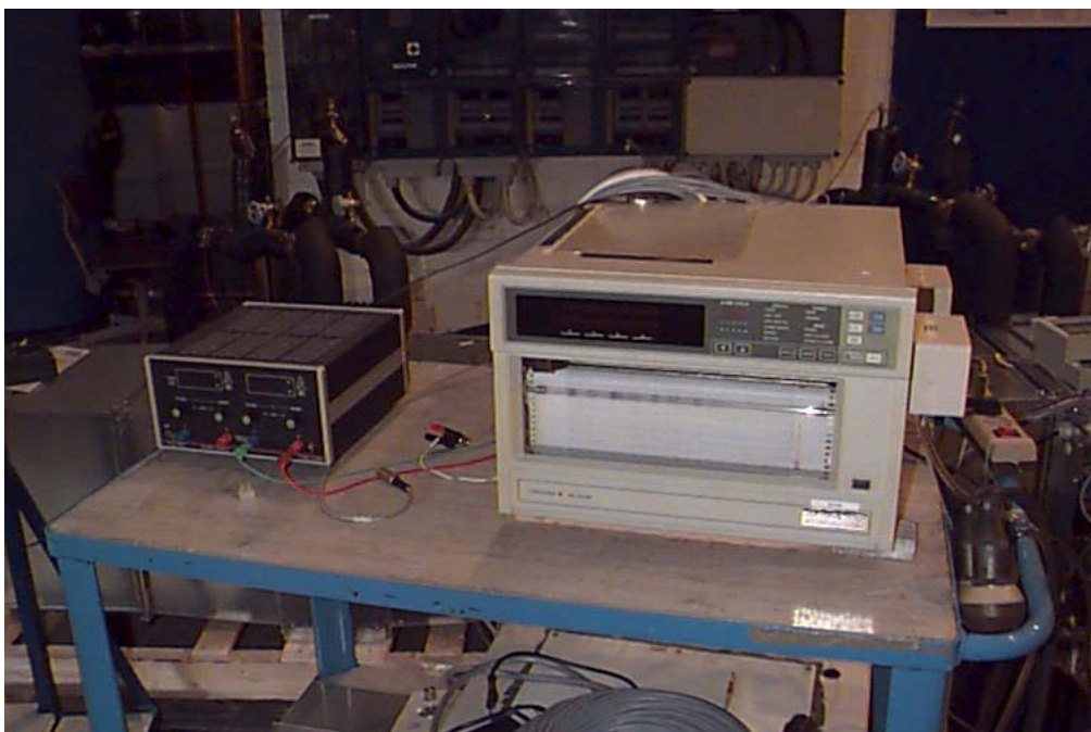
Slika 5.2 Prikaz mjernog instrumenta za mjerenje temperature
