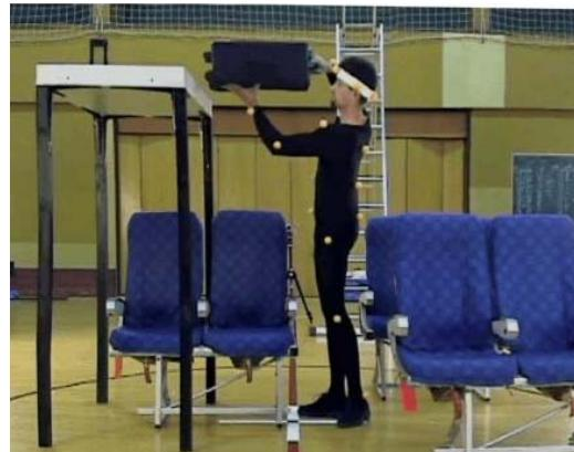
**Sl. 89.** Kinematogram slijedeњa ispitanika mocap sustavom VatoSABA 2.1.
