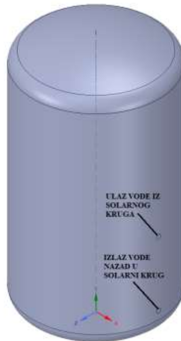
Slika 32 Geometrija spremnika (3D model)
