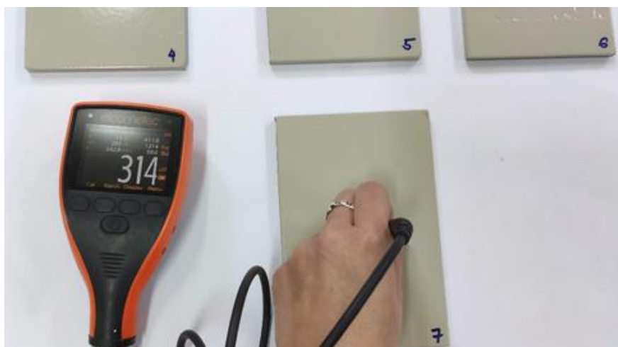
Slika 5.23. Mjerenje DSF-a uređajem Elcometer 456
