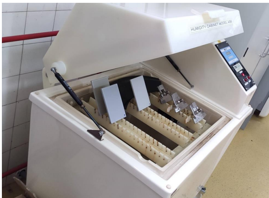
Slika 5.38. Vlažna komora, Laboratorij za zaštitu materijala, FSB
