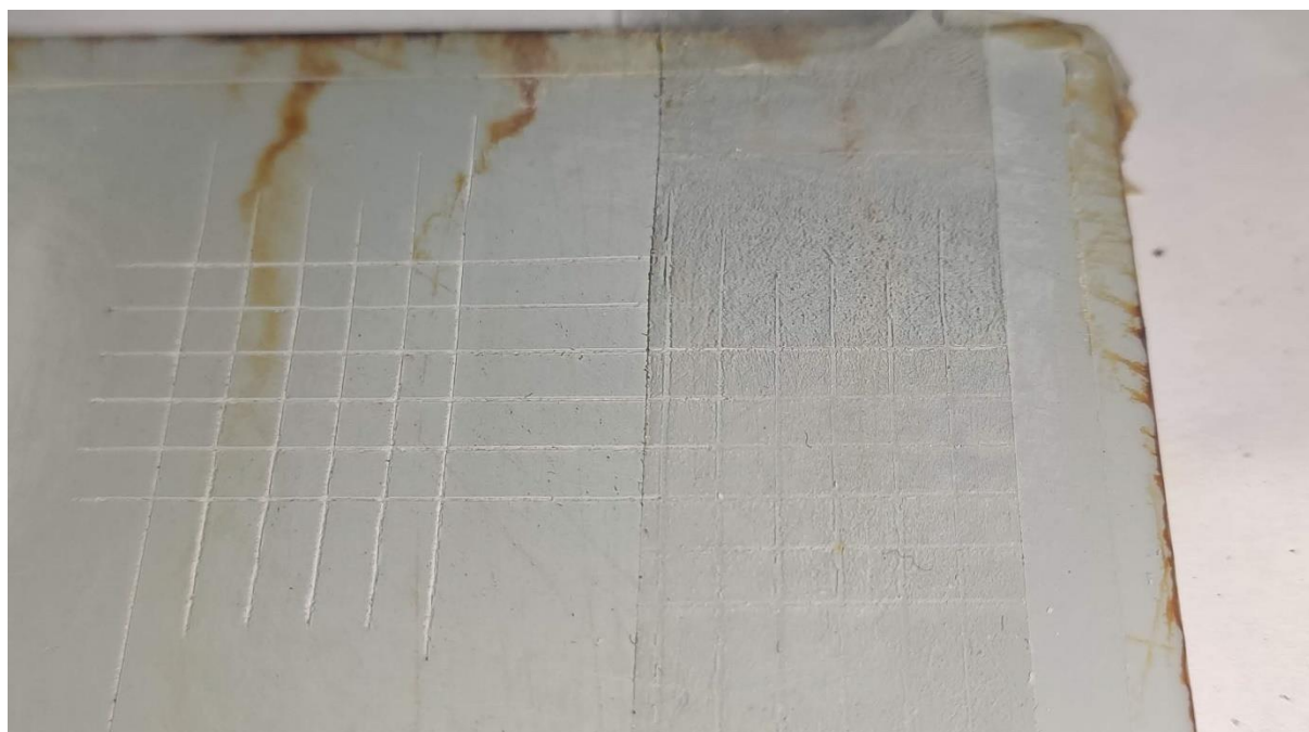
Slika 5.49. Rezultat Cross cut ispitivanja na uzorku broj 2
