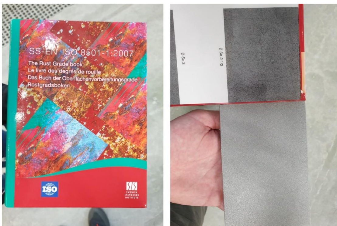
Slika 5.2. Određivanje razreda čistoće površine prema normi ISO 8501-1
