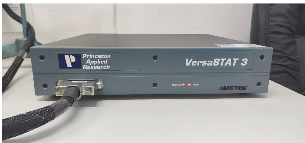
Slika 5.29. Uređaj za provođenje EIS ispitivanja, VersaSTAT 3, Laboratorij za zaštitu materijala, FSB
