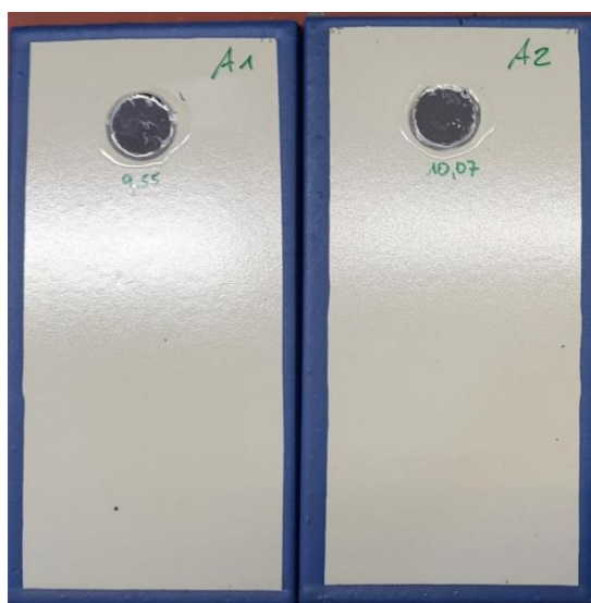
Slika 5.18. Rezultati Pull off ispitivanja prionjivosti na referentnim Chingovim uzorcima A1 i A2
