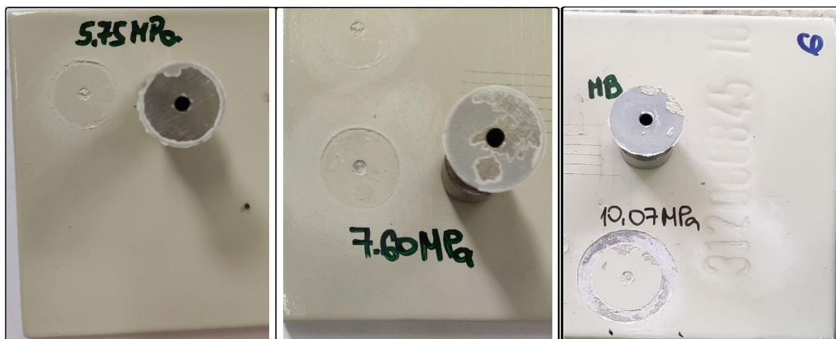
Slika 5.27. Rezultati Pull off testa na uzorku br. 6
