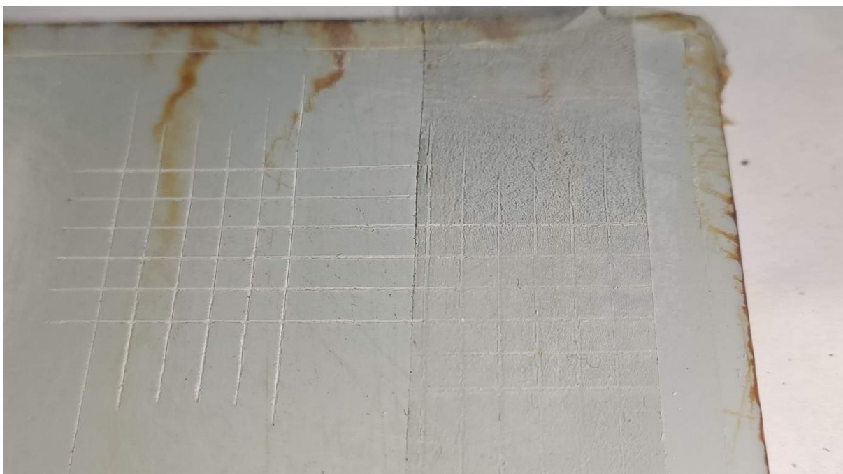
Slika 5.49. Rezultat Cross cut ispitivanja na uzorku broj 2
