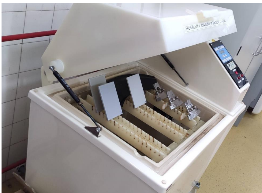
Slika 5.38. Vlažna komora, Laboratorij za zaštitu materijala, FSB
