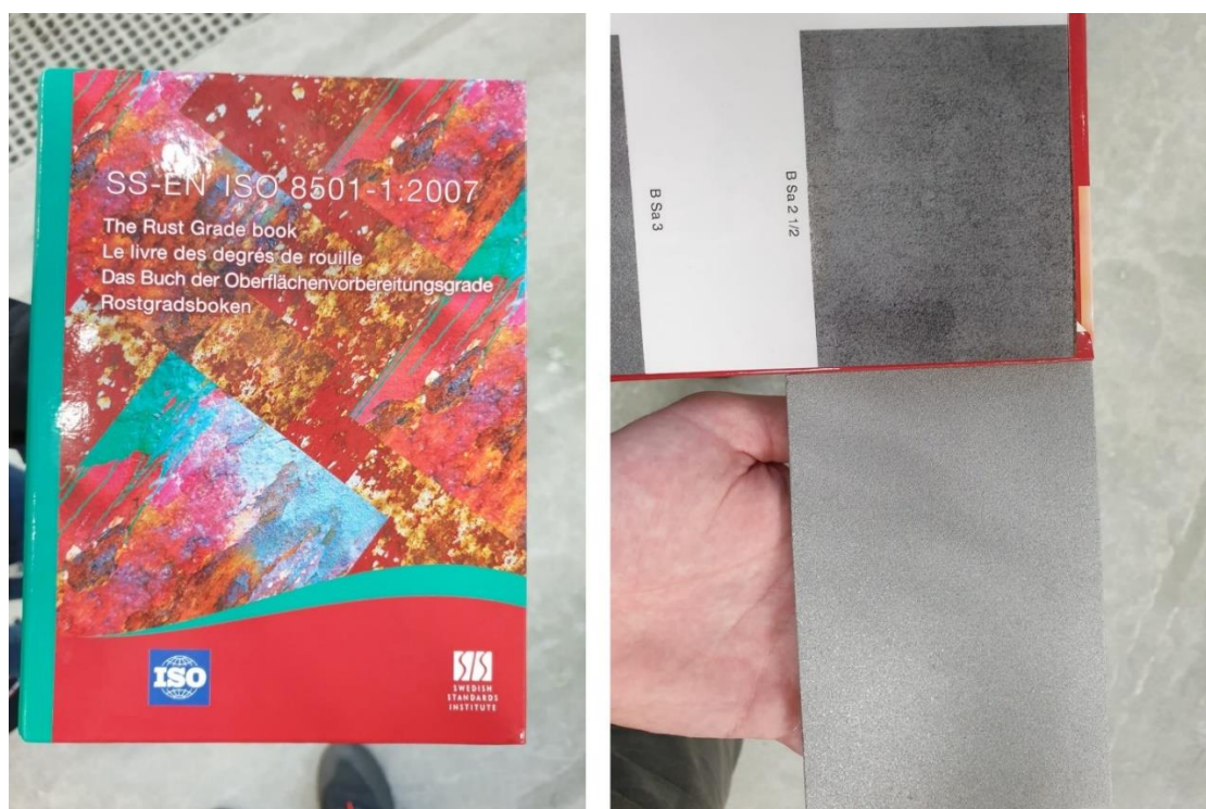
Slika 5.2. Određivanje razreda čistoće površine prema normi ISO 8501-1
