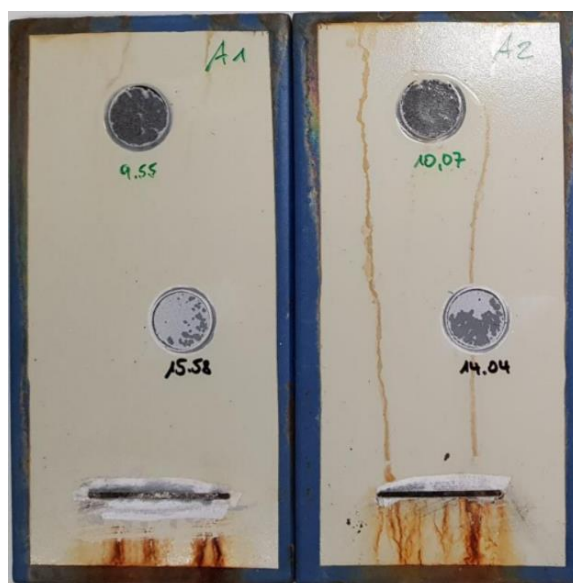
Slika 5.20. Rezultati Pull off testiranja nakon slane komore, na referentnim Chingovim uzorcima A1 i A2
