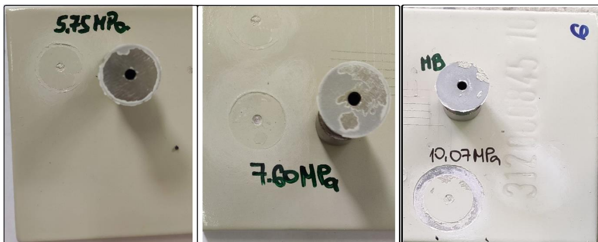
Slika 5.27. Rezultati Pull off testa na uzorku br. 6
