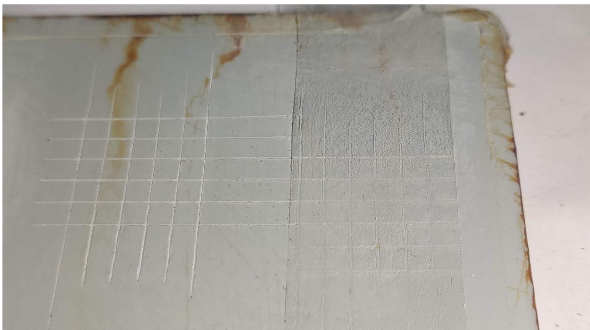
Slika 5.49. Rezultat Cross cut ispitivanja na uzorku broj 2
