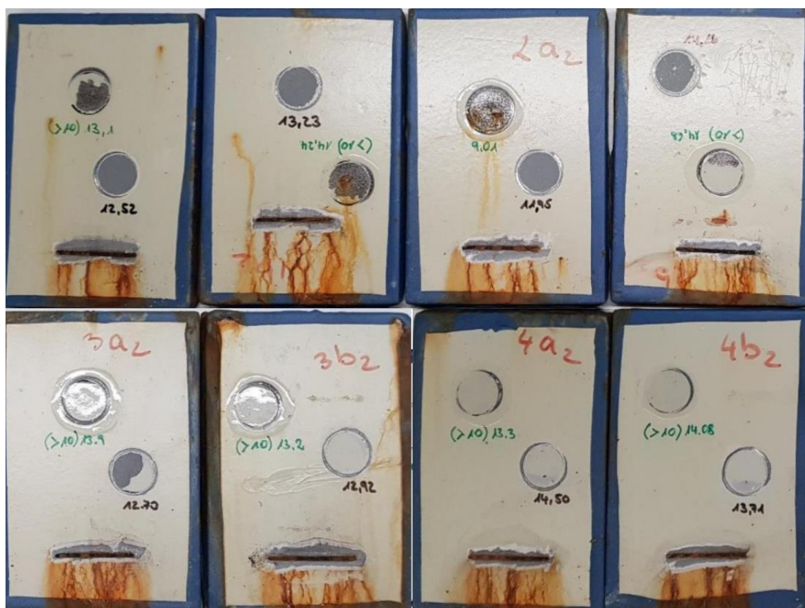
Slika 5.20. Rezultati Pull off testiranja nakon slane komore, na referentnim Chingovim uzorcima A1 i A2
