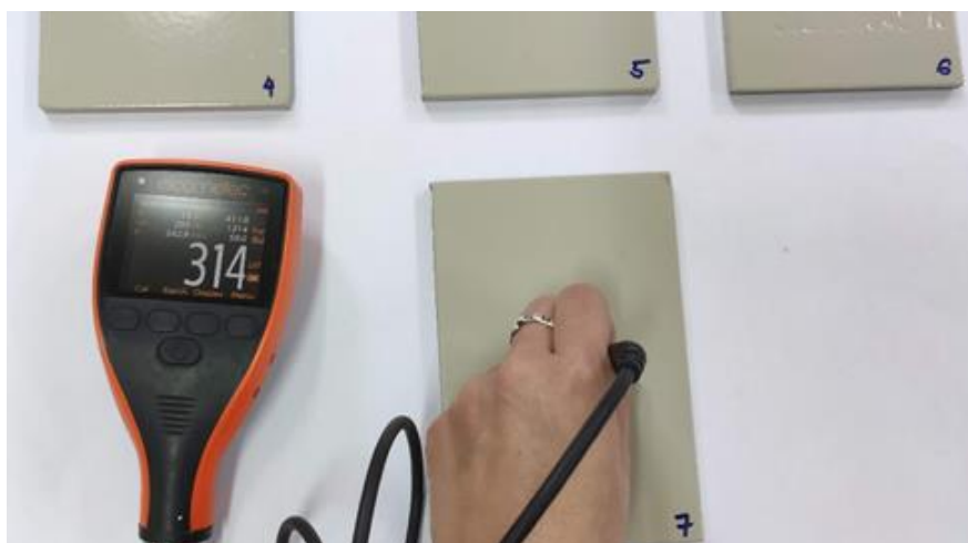
Slika 5.23. Mjerenje DSF-a uređajem Elcometer 456
