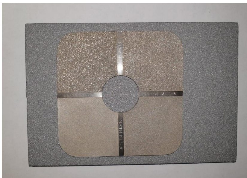
Slika 5.3. Određivanje hrapavosti komparatorom prema normi ISO 8503
