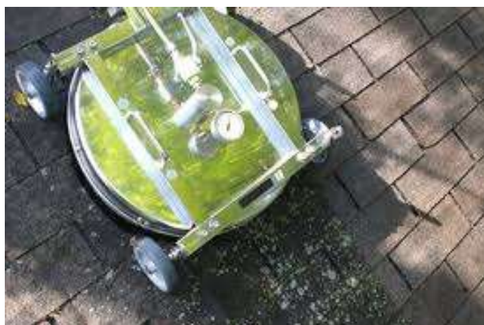
Slika 35. Mosmatic uređaj na šindri [18]
