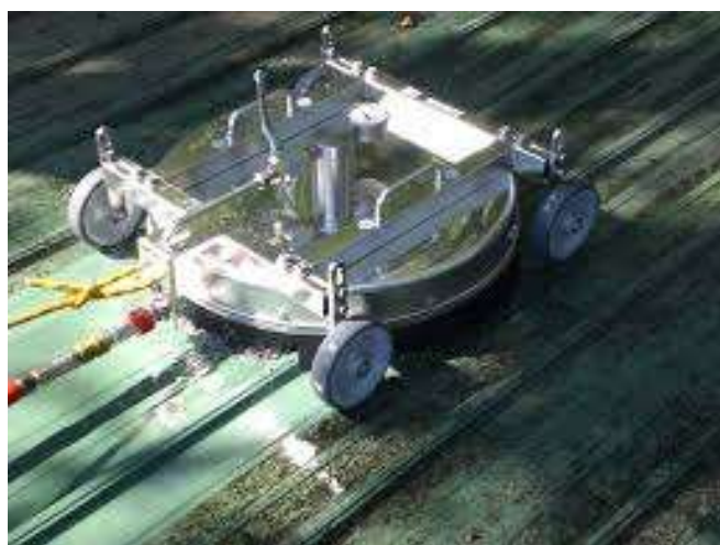
Slika 36. Mosmatic uređaj na limenom pokrovu [18]
