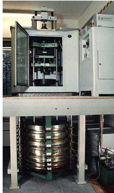
Slika 2.10: Primarni etalon tvrdoće u PTB-u [12]
