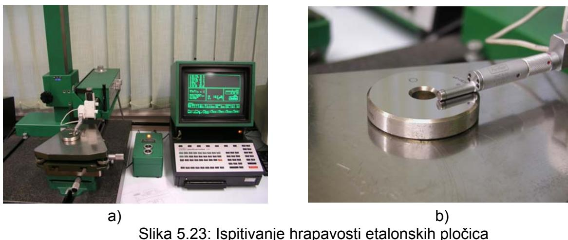
Slika 5.23: Ispitivanje hrapavosti etalonskih pločica
