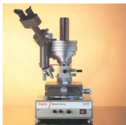
Slika 2.12: Tvrdomjeri u ispitnim mjeriteljskim laboratorijima
