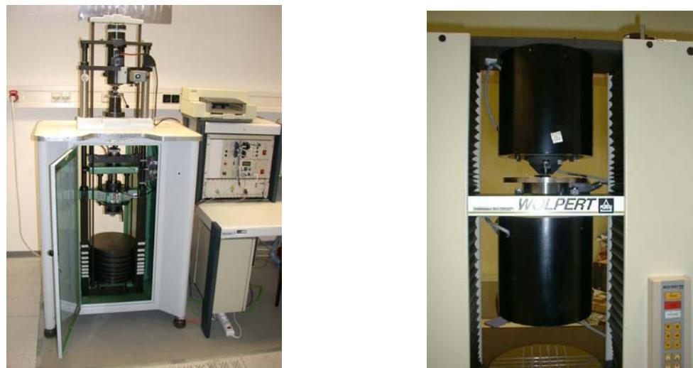
Slika 2.11: Referentni etaloni tvrdoće
