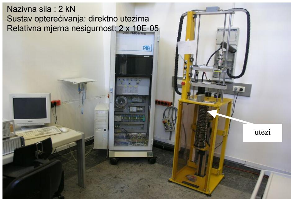
Slika 2.3: Nacionalni etalon sile Njemačke u PTB-u
