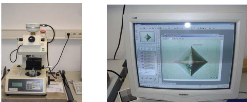
Slika 5.27: Njemački nacionalni etalon tvrdoće za metodu HV1
