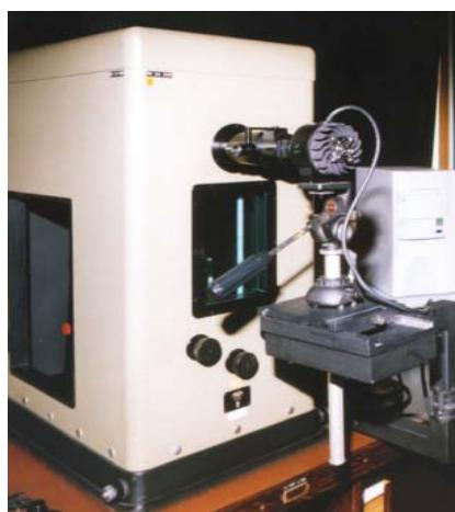
Slika 5.22: Interferencijski mikroskop Carl Zeiss
