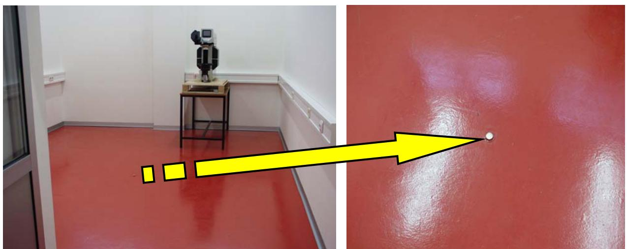
Slika 5.4: Točka gravimetrijskih i nivelmanskih mjerena u LIMS-u
