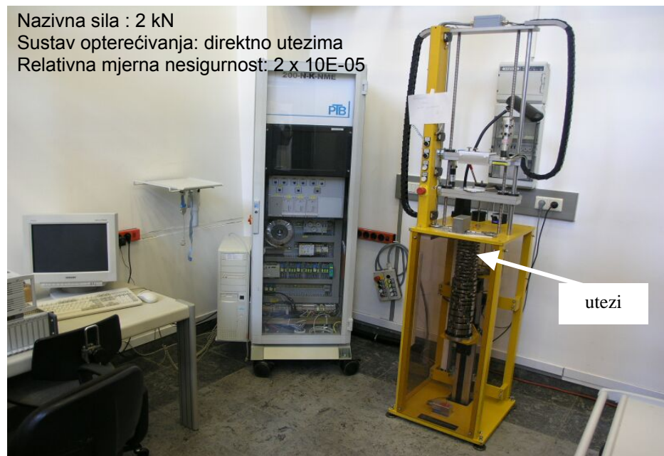
Slika 2.3: Nacionalni etalon sile Njemačke u PTB-u
