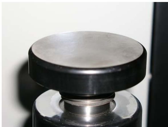
Slika 5.10: Ispitni stol sustava za opterećivanje 5030TKV
