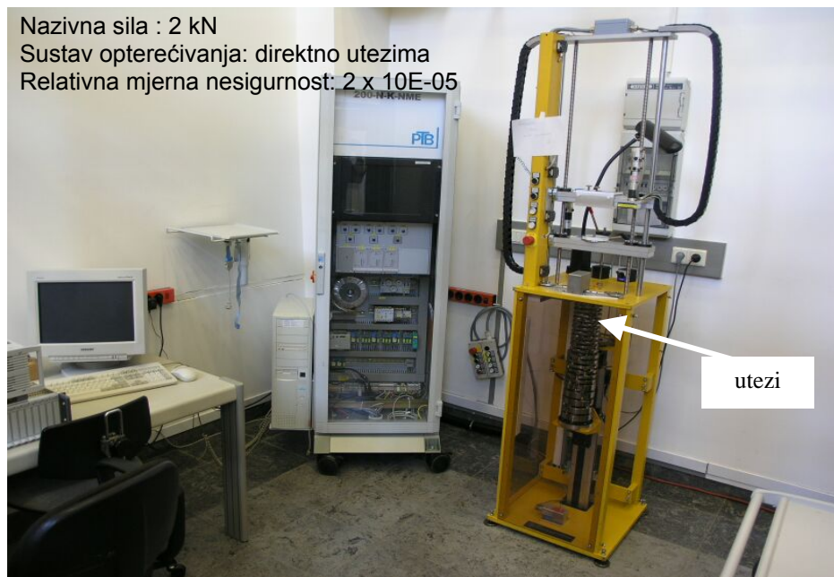
Slika 2.3: Nacionalni etalon sile Njemačke u PTB-u
