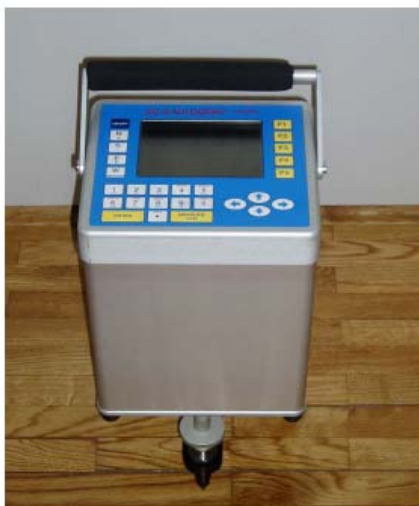
Slika 5.2: Relativni gravimetar Scintrex CG-5
