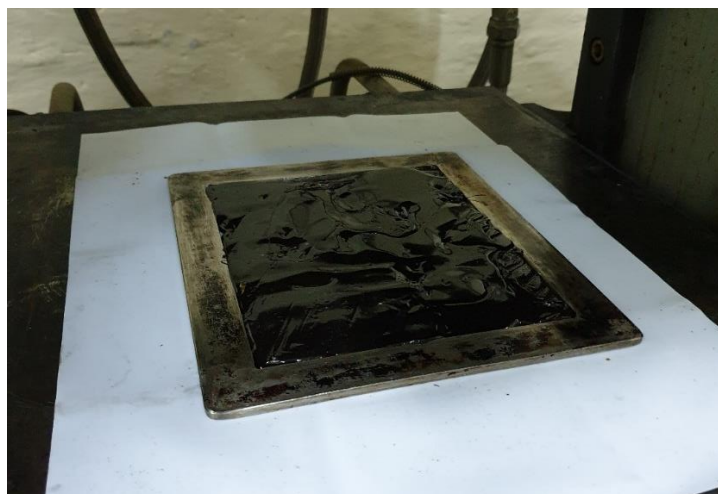
Slika 6.36. Smjesa u stvrdnutom stanju stavljena u kalup
