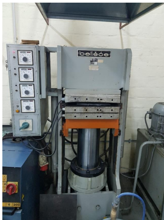
Slika 6.33. Hidraulička preša za izravno toplo prešanje
