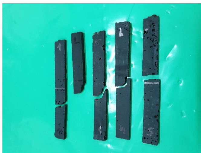
Slika 6.45. Ispitna tijela od PLA i 40 % ljuski lješnjaka nakon ispitivanja žilavosti
