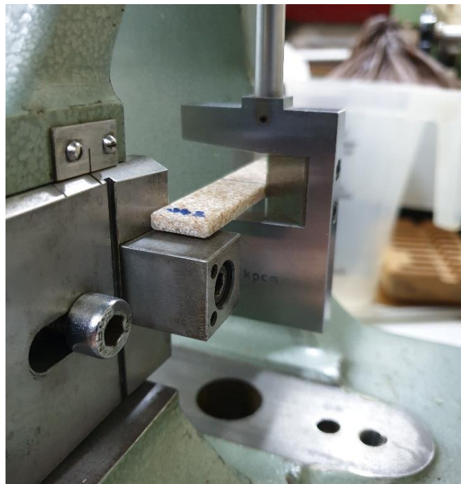
Slika 6.18. Ispitivanje žilavosti na ispitnom tijelu J40-2
