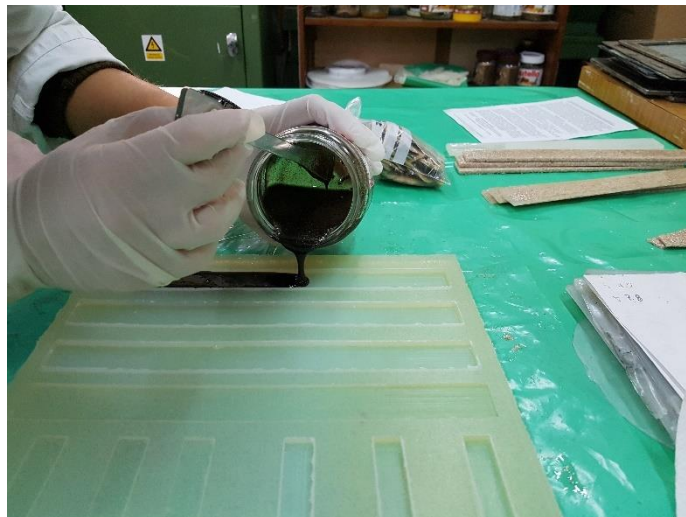
Slika 6.14. Lijevanje mješavine u kalup
