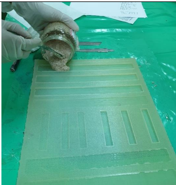
Slika 6.9. Lijevanje mješavine u silikonski kalup
