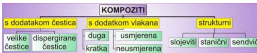
Slika 2.3. Podjela kompozita po obliku i veličini ojačavala [6]
