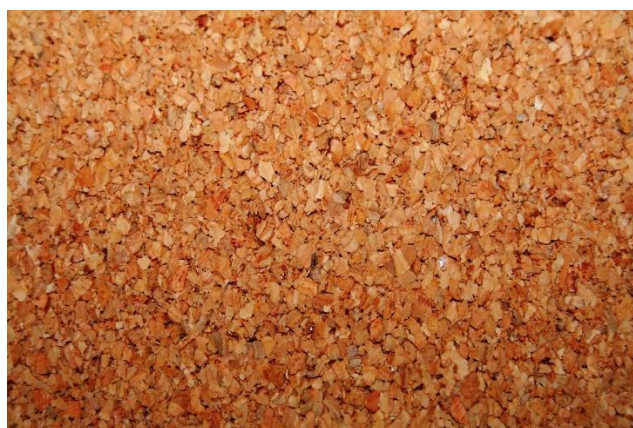
Slika 4.3. Usitnjeni pluteni materijal [24]
