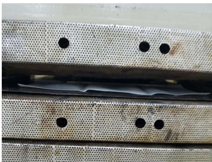
Slika 6.37. Omekšani materijal u kalupu
