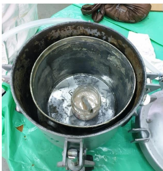
Slika 6.7. Izvlačenje zraka iz smjese u potlačnoj komori
