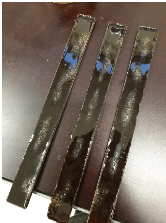
Slika 6.15. Umrežen kompozit izvađen iz kalupa
