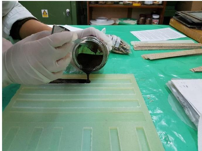
**Slika 6.14. Lijevanje mješavine u kalup**
