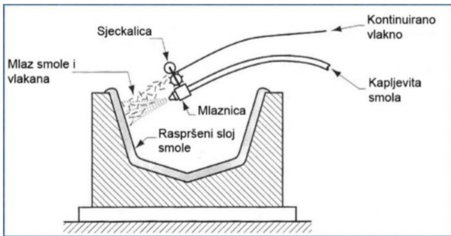
Slika 3.11. Oprema kod dodirnog postupka štrcanjem [14]
