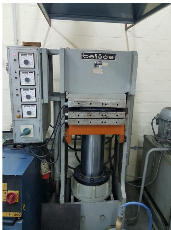
Slika 6.33. Hidraulička preša za izravno toplo prešanje
