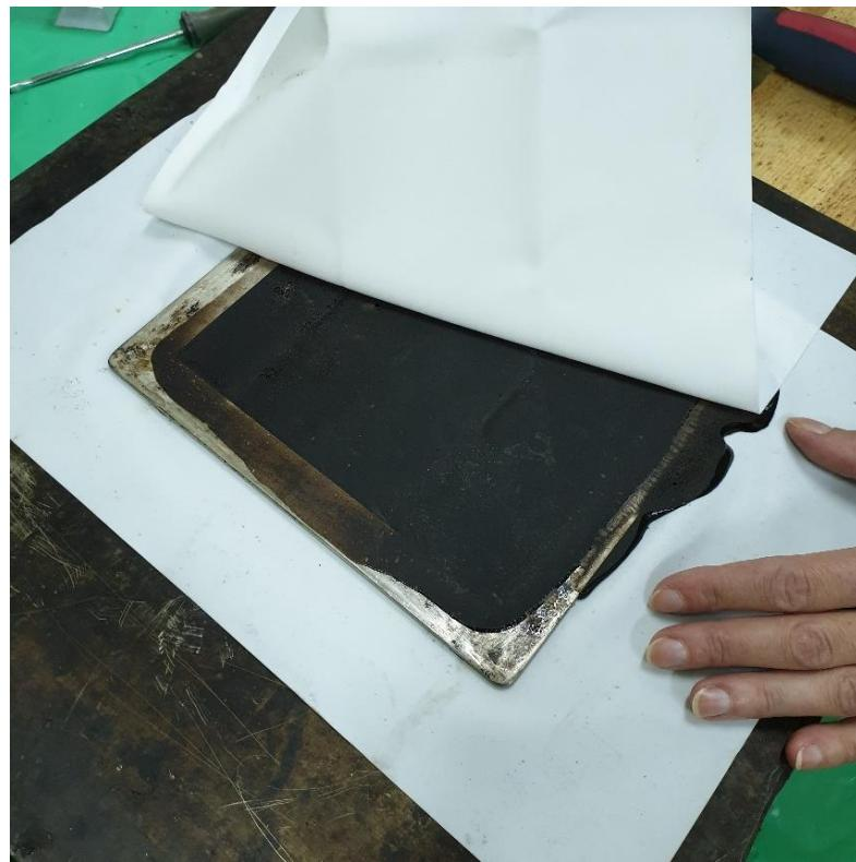
Slika 6.40. Odvajanje silikonske podloge i vađenje otpreska
