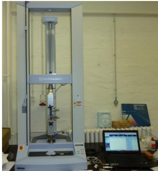
Slika 6.21. Kidalica *Shimadzu AGS-X*
