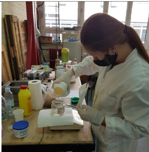
Slika 6.11. Priprema smole za izradu kompozita
