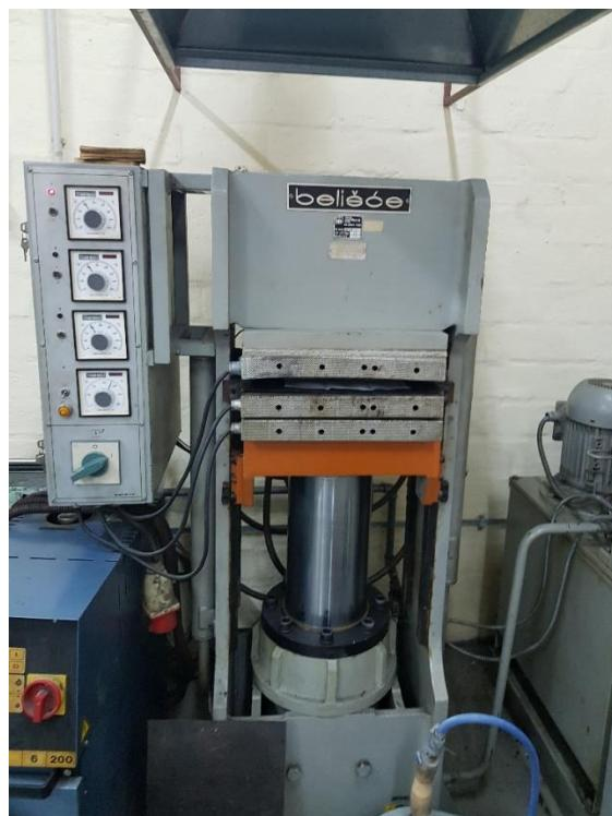
Slika 6.33. Hidraulička preša za izravno toplo prešanje
