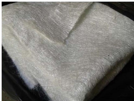
Slika 3.4. Stakleni predoblik (prošiveni mat) [12]
