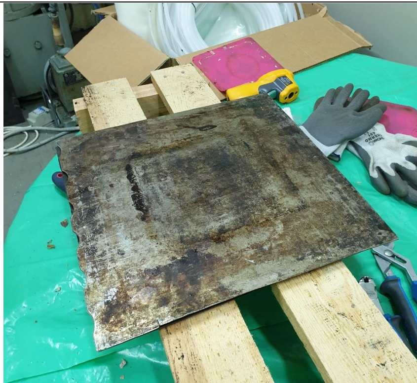
Slika 6.39. Hladenje kalupa pri sobnoj temperaturi
