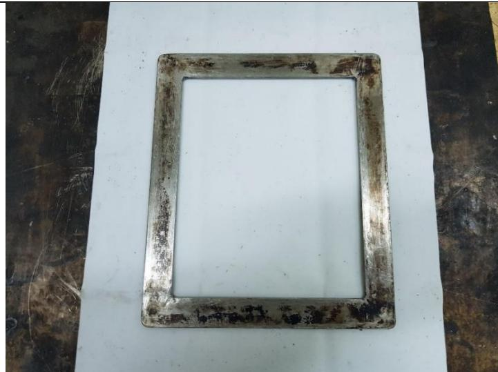
Slika 6.32. Kalup za izradu kompozita s PLA matricom
