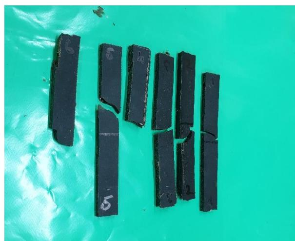
Slika 6.44. Ispitna tijela od PLA i 20 % ljudskih lješnjaka nakon ispitivanja žilavosti
