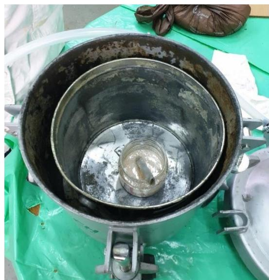
Slika 6.7. Izvlačenje zraka iz smjese u potlačnoj komori
