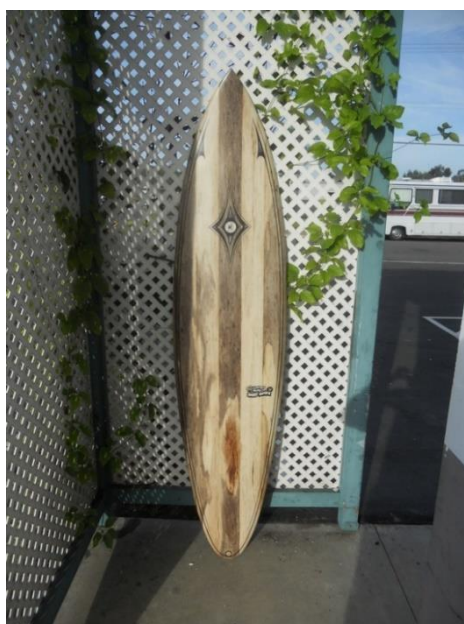
Slika 4.2. Daska za surfanje od agave [20]
