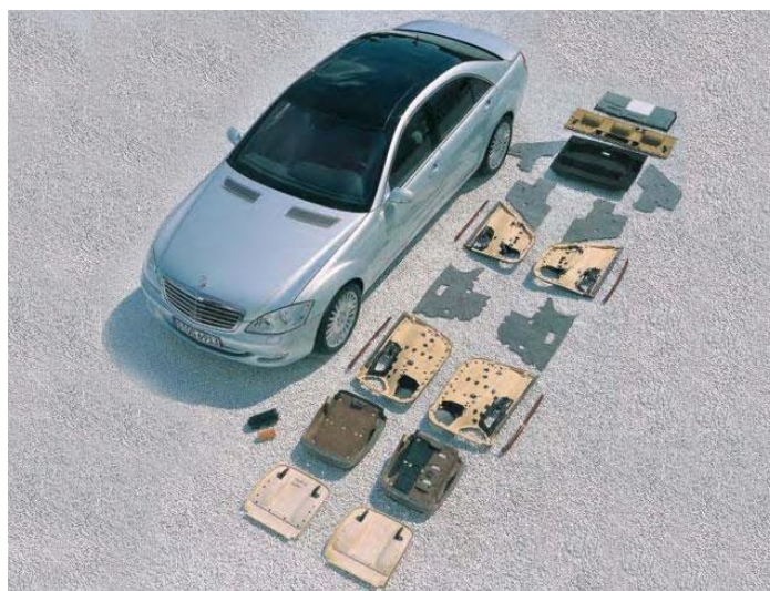
Slika 4.7. Dijelovi automobila napravljeni od prirodnih kompozita [33]
