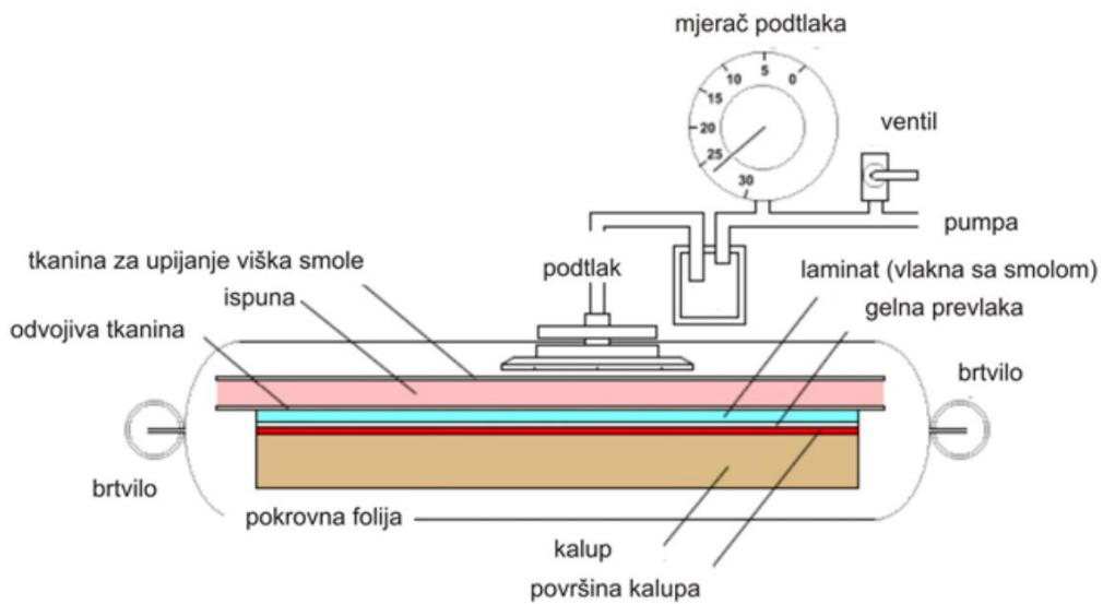
Slika 3.15. Oprema kod podtlačnog oblikovanja vrećom [14]
