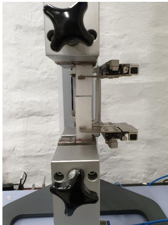
**Slika 6.23. Ispitno tijelo E-1 nakon ispitivanja rasteznih svojstava**
