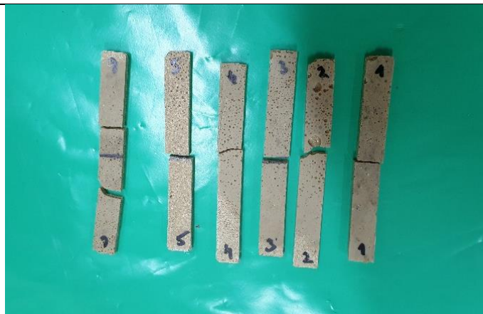
Slika 6.43. Ispitna tijela od PLA i 40 % ljuski jaja nakon ispitivanja žilavosti
