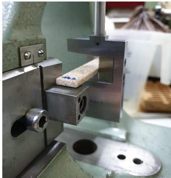
**Slika 6.18. Ispitivanje žilavosti na ispitnom tijelu J40-2**
