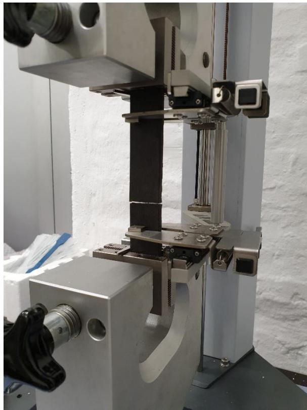
**Slika 6.26. Ispitno tijelo LJ20-3 nakon ispitivanja na kidalici**
