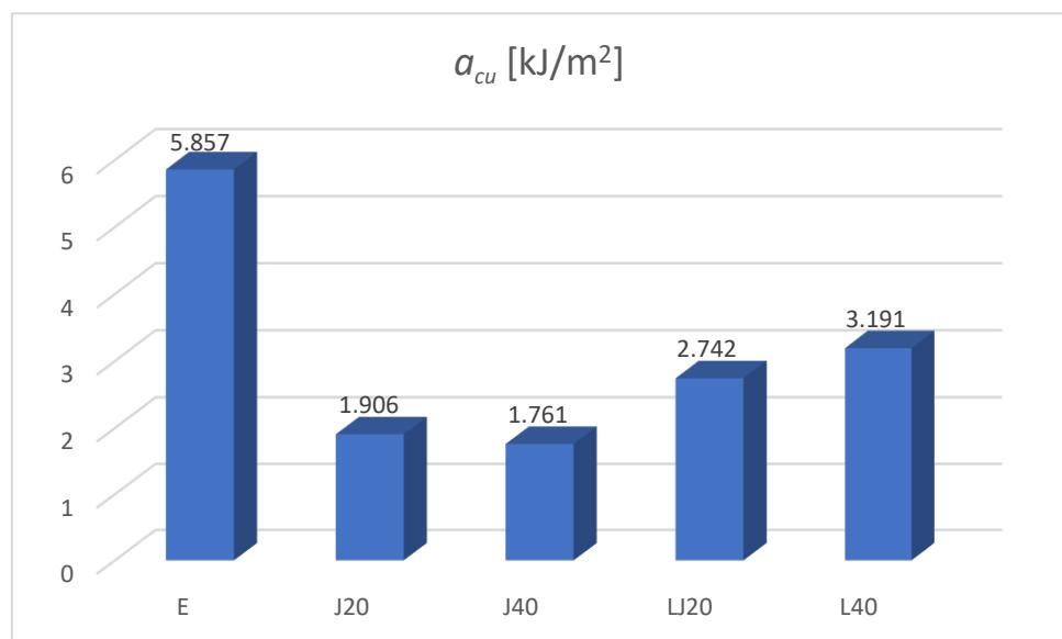
**Slika 6.20. Dijagram usporedbenje vrijednosti žilavosti svih kompozita**
