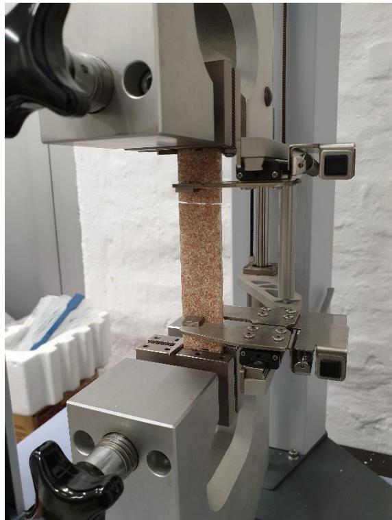
**Slika 6.24. Ispitno tijelo J20-3 nakon ispitivanja na kidalici**
