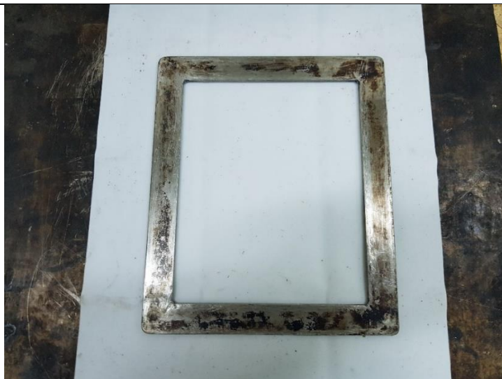
Slika 6.32. Kalup za izradu kompozita s PLA matricom
