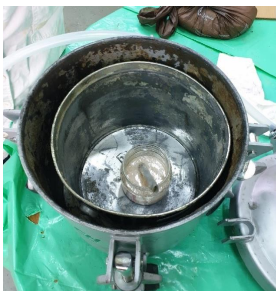
Slika 6.7. Izvlačenje zraka iz smjese u potlačnoj komori
