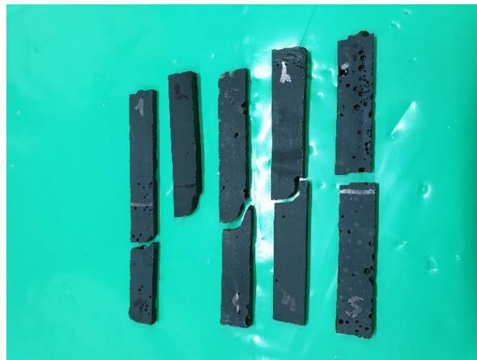
**Slika 6.45. Ispitna tijela od PLA i 40 % ljski lješnjaka nakon ispitivanja žilavosti**
