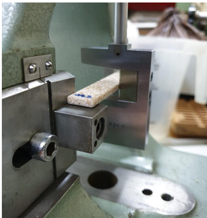
Slika 6.18. Ispitivanje žilavosti na ispitnom tijelu J40-2
