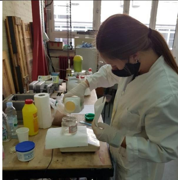
Slika 6.11. Priprema smole za izradu kompozita
