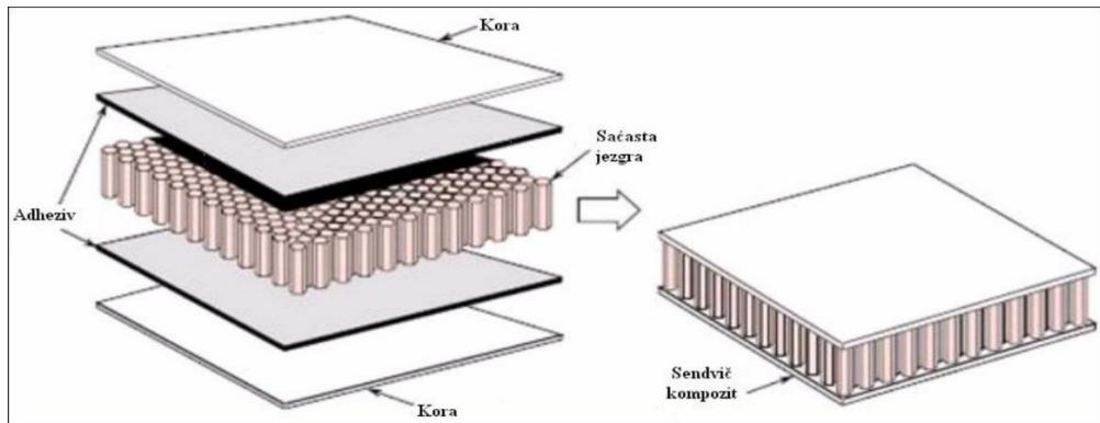
Slika 2.6. Struktura sendvič konstrukcije kompozita [8]
