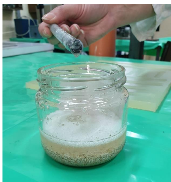
Slika 6.7. Izvlačenje zraka iz smjese u potlačnoj komori
