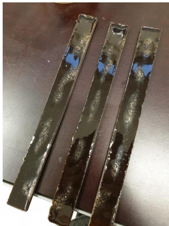
**Slika 6.15. Umrežen kompozit izvađen iz kalupa**
