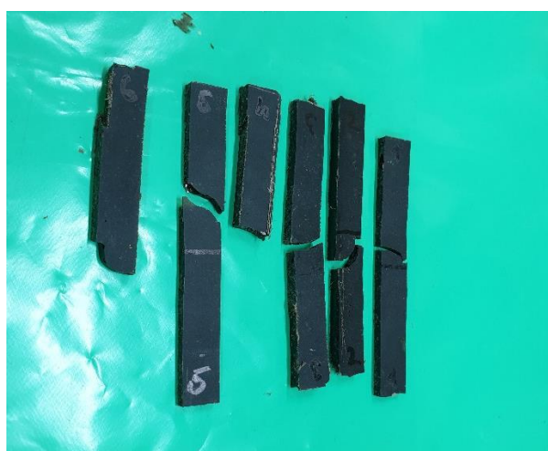
Slika 6.44. Ispitna tijela od PLA i 20 % ljuski lješnjaka nakon ispitivanja žilavosti
