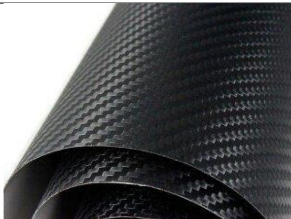
Slika 3.3. Kompozit s ugljičnim vlaknima i polimernom matricom [13]
