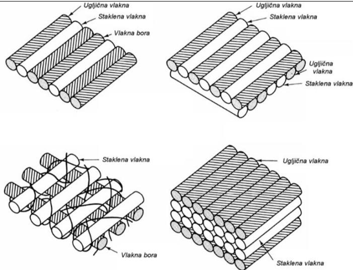
**Slika 3.6 Različiti načini slaganja staklenih i ugljičnih vlakana [12]**
