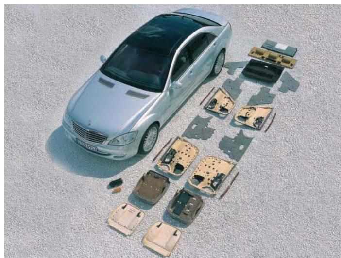
**Slika 4.7. Dijelovi automobila napravljeni od prirodnih kompozita [33]**
