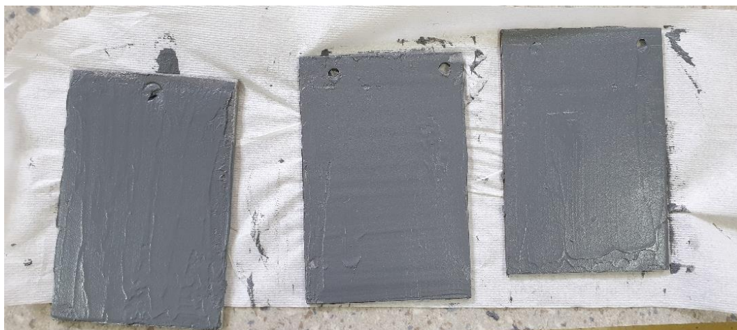
Slika 7.17. Uzorci nakon nanošenja premaza Belzona 1212
