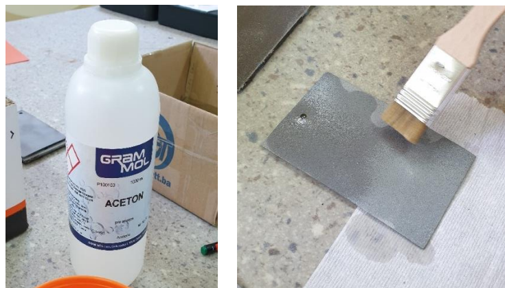
Slika 7.4. Odmašćivanje površine uzoraka acetonom
