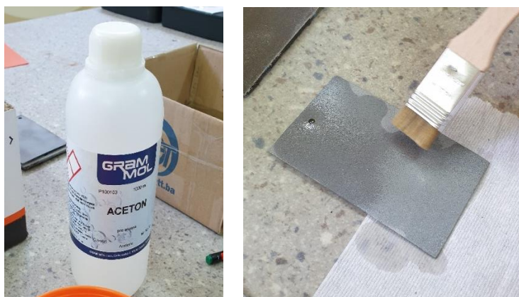
Slika 7.4. Odmašćivanje površine uzoraka acetonom
