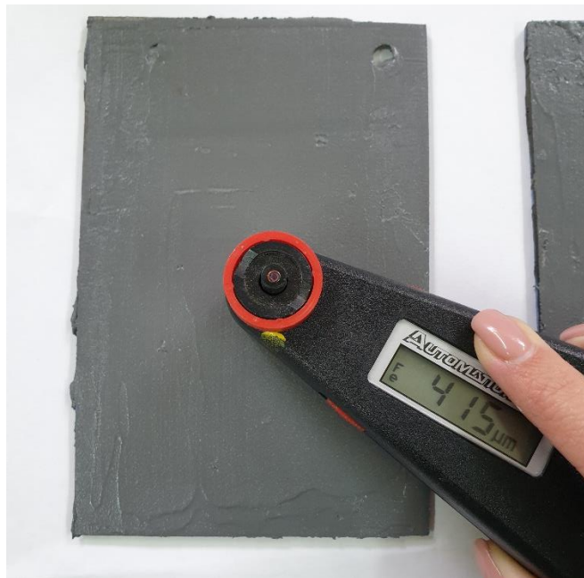
Slika 7.23. Mjerenje debljine filma premaza pomoću uređaja QuaNix 1500
