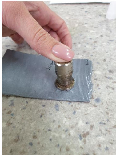
Slika 7.36. Postupak pripreme za Pull – off ispitivanje: a) hrapavljenje površine brusnim papirom, b) korišteno ljepilo te njegovo nanošenje, c) prislanjanje valjčića na površinu premaza, d) stvrdnjavanje ljepila
