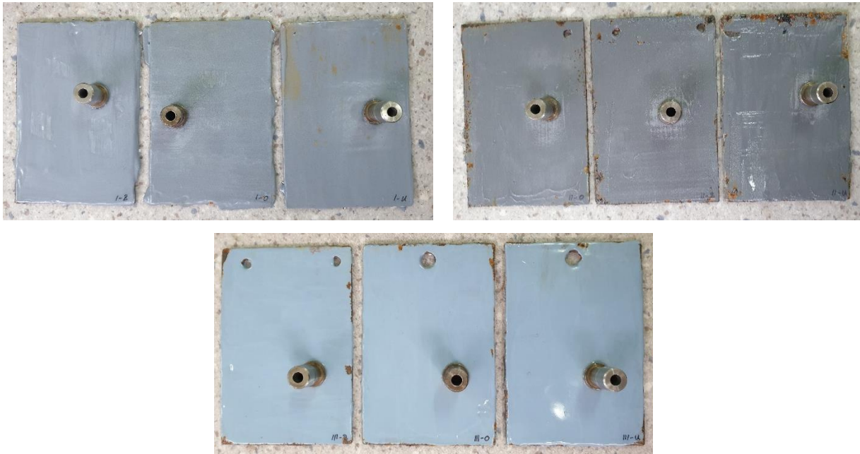
Slika 7.47. Uzorci pripremljeni za Pull – off ispitivanje
