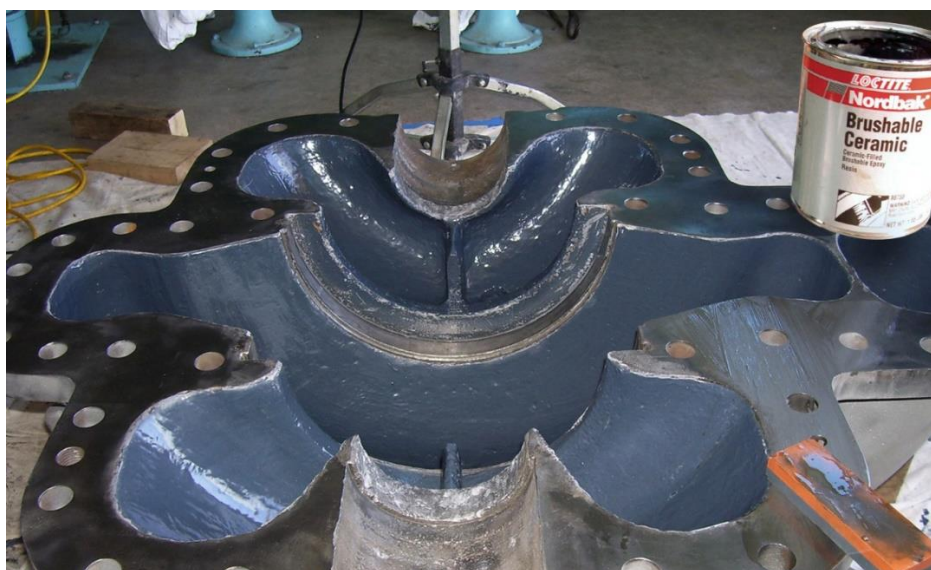
Slika 5.9. Unutrašnjost pumpe nakon premazivanja epoksidom, ojačanim s keramičkim kuglicama [24]
