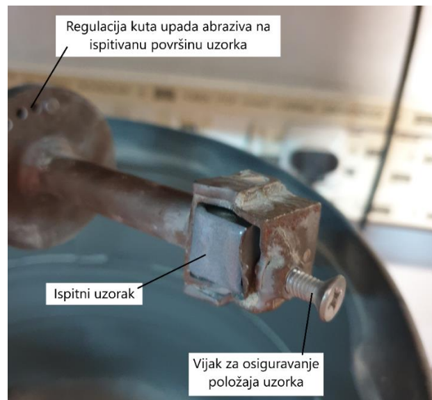
Slika 7.31. Ispitni uzorak u držaču prije početka ispitivanja otpornosti na erozijsko trošenje
