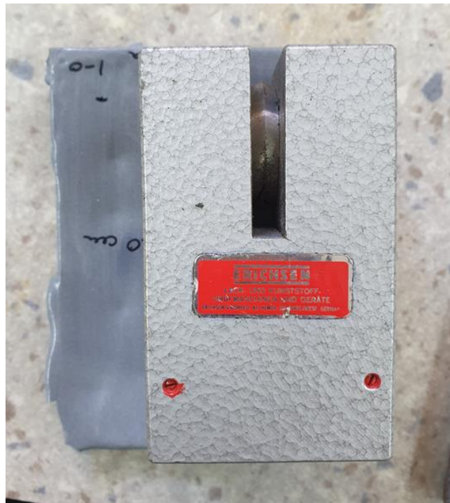
Slika 7.38. Ispitivanje tvrdoće prema Buchholzovom modelu 263
