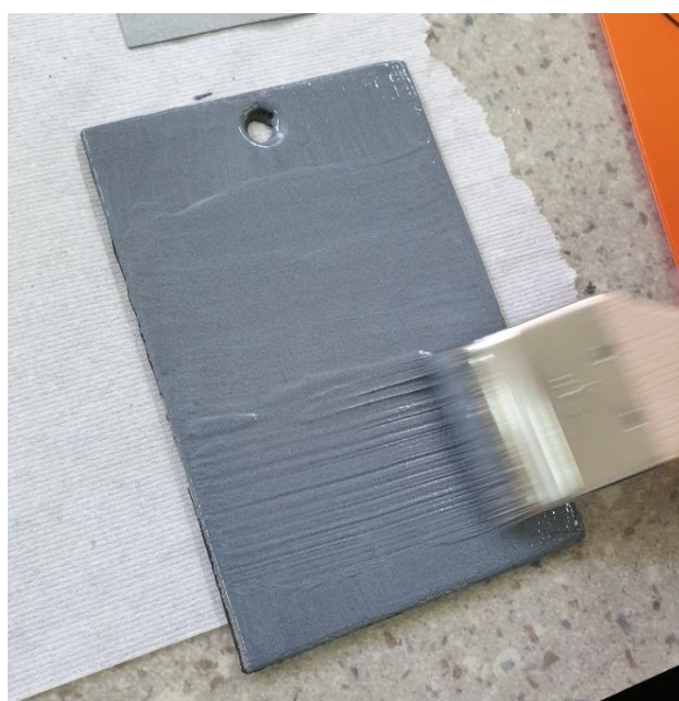
Slika 7.13. Nanošenje Belzona 1321 premaza na ispitni uzorak
