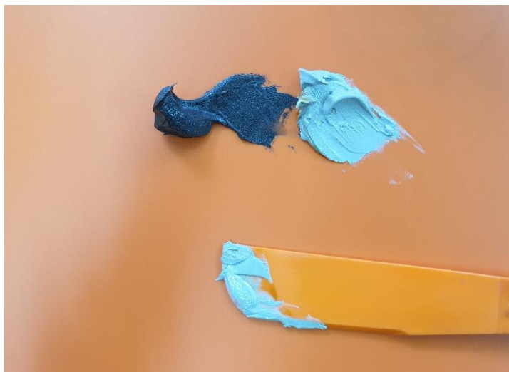
Slika 7.16. Određivanje potrebne količine komponenti Belzona 1212
