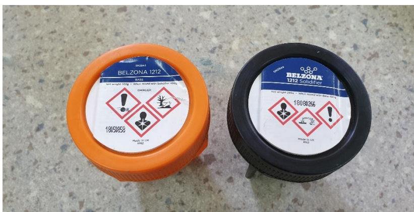
Slika 7.8. Belzona 1212 epoxy kompozit
