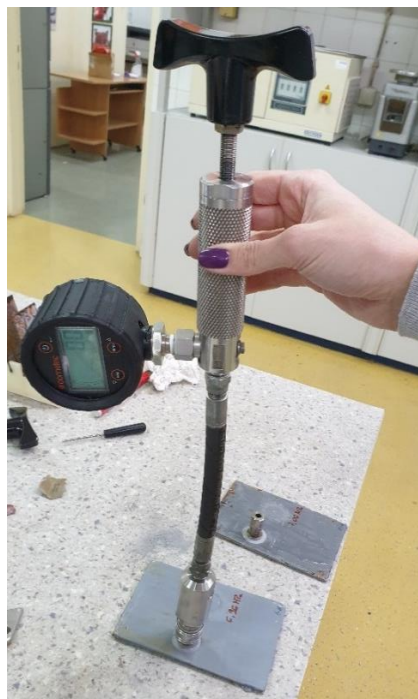
Slika 7.48 Ispitivanje prionjivosti premaza Pull – off metodom
