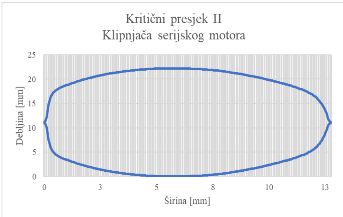
Slika 33. Kritični presjek II klipnjače serijskog motora
