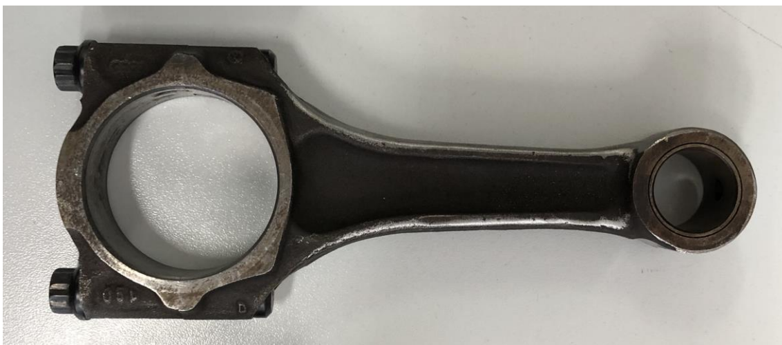
Slika 14. Klipnjača serijskog motora s I-profilom
