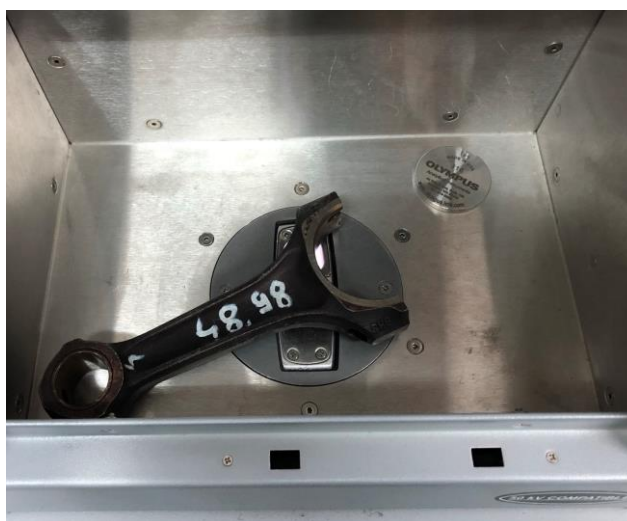
Slika 16. Postupak snimanja klipnjače XRF analizatorom
