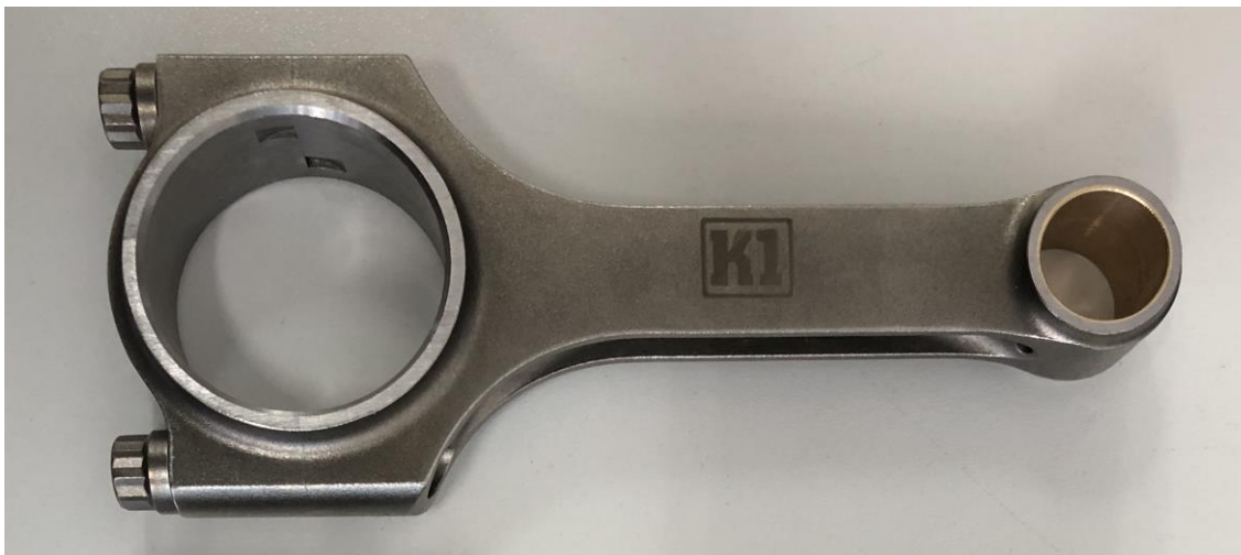
Slika 15. Klipnjača trkaćeg motora s H-profilom
