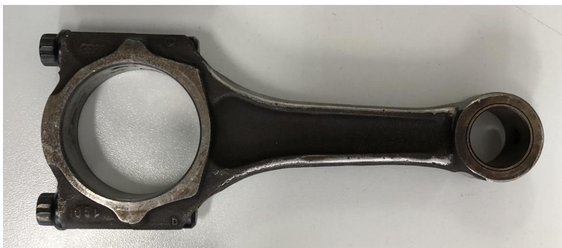
Slika 14. Klipnjača serijskog motora s I-profilom
