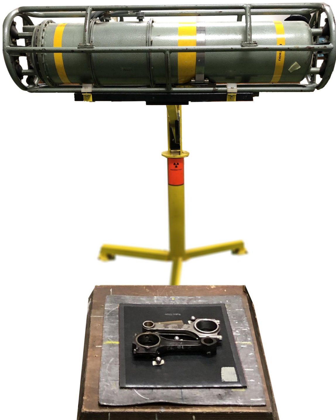
Slika 17. Postupak prozračivanja RTG uređajem
