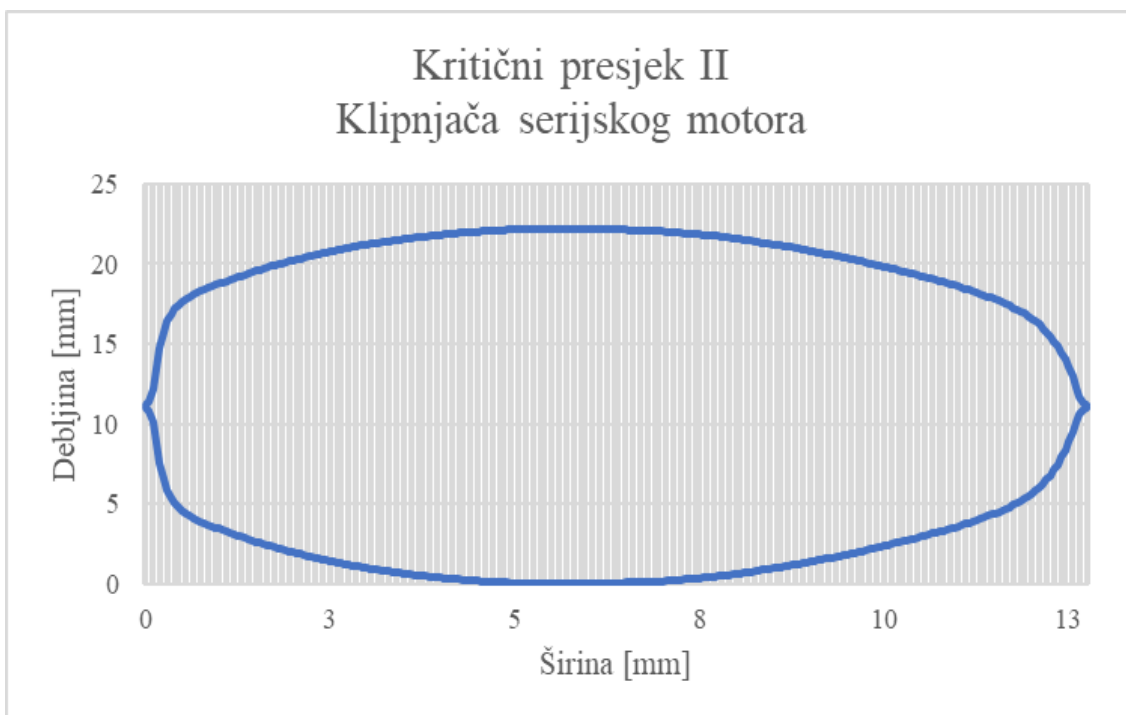
Slika 33. Kritični presjek II klipnjače serijskog motora
