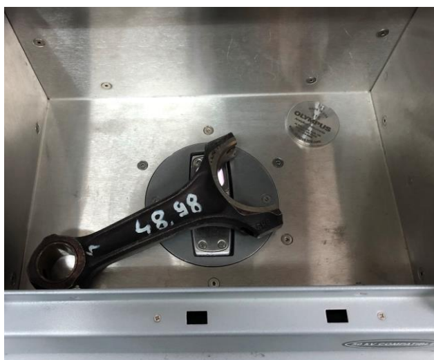
Slika 16. Postupak snimanja klipnjače XRF analizatorom
