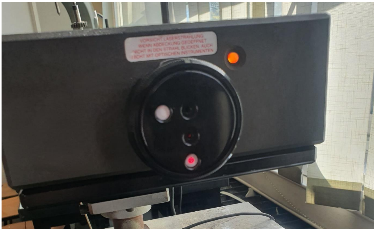
Slika 30 Prikaz dobro poravnatog retroreflektora na piezu
