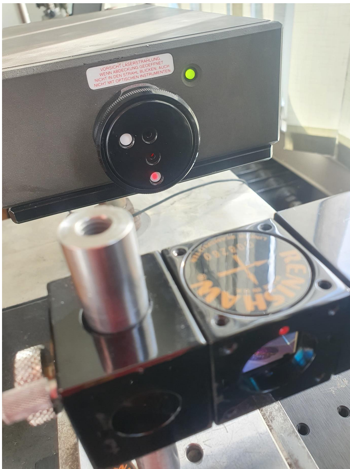
Slika 34 Poravnati razdjelnik snopova sa retroreflektorom
