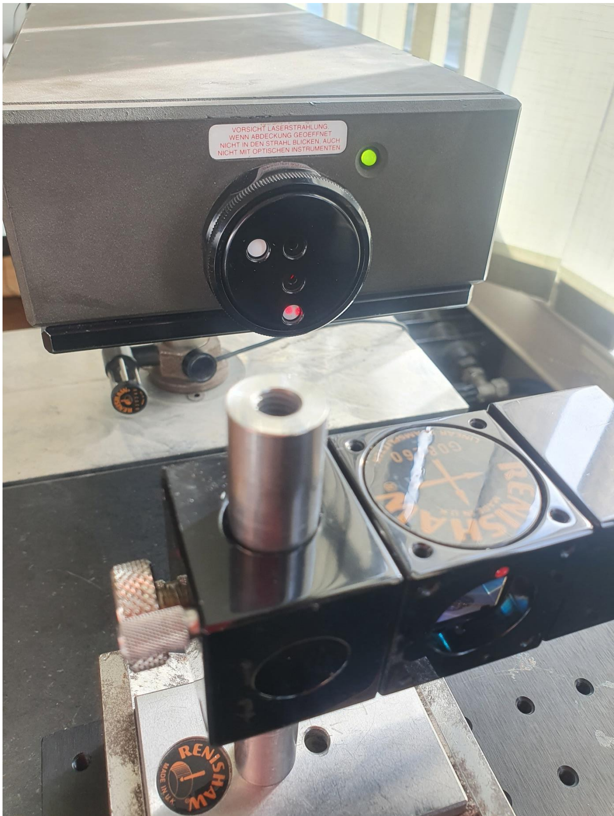
Slika 33 Neporavnati razdjelnik snopova sa retroreflektorom
