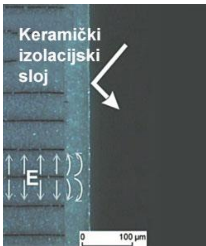
Slika 9 Prikaz keramičkog izolacijskog sloja
