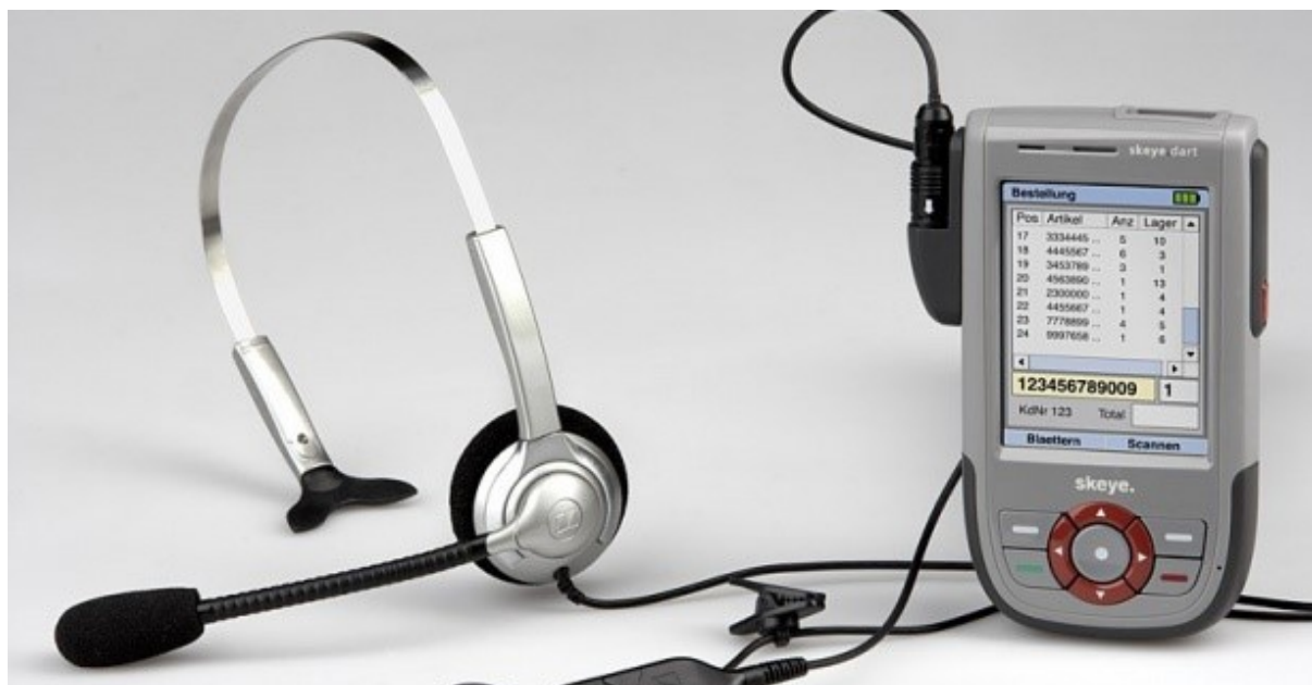
Slika 32. Slušalice s mikrofonom i RF terminal [17]
