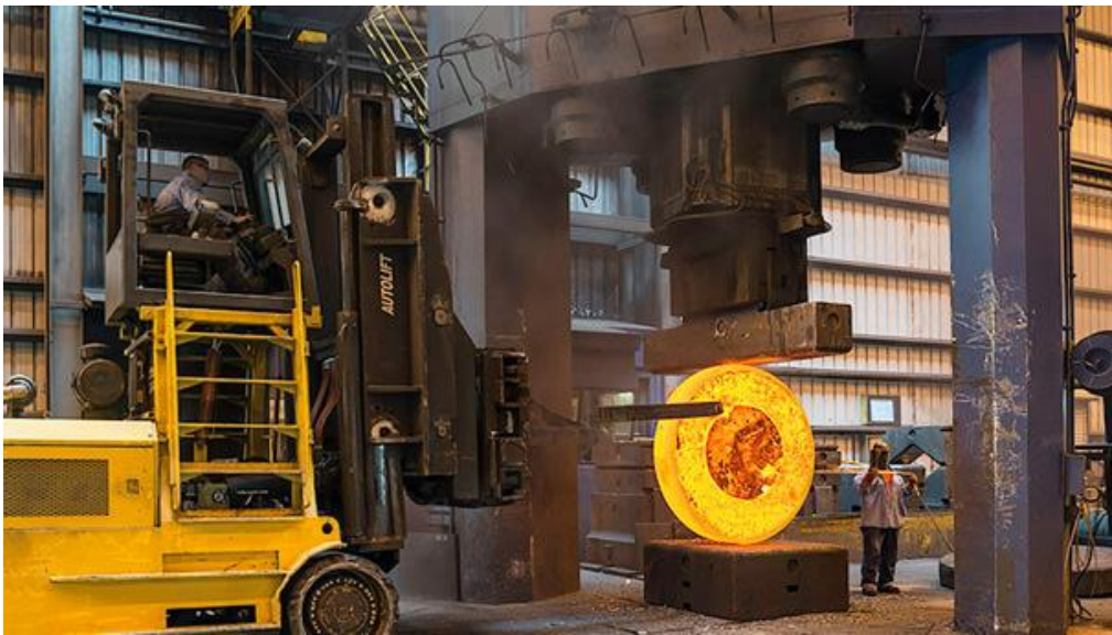
Slika 16. Postupak kovanja u toplom stanju [17]
