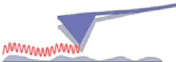
Slika 20. Princip beskontaktnog načina rada AFM-a [24]
