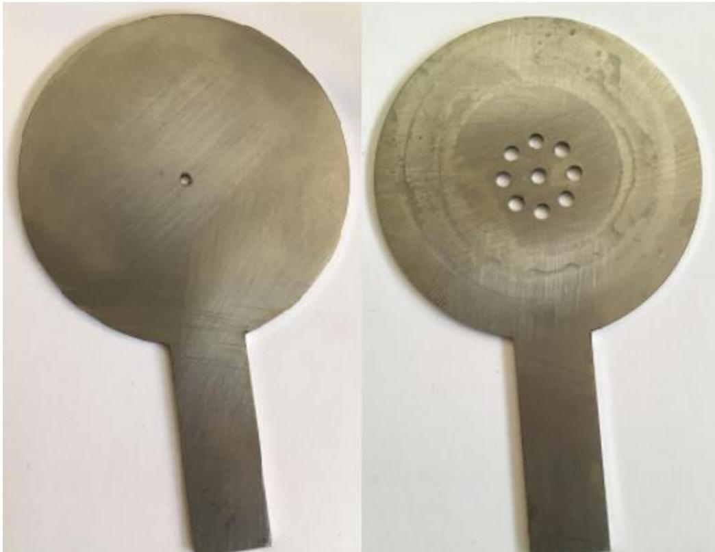
**Slika 11.** Mjerne prigušnice (2 mm i 9x3 mm)
