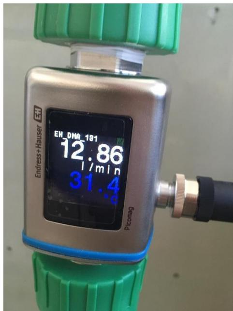
**Slika 9.** Elektromagnetski protokomjer Endress Hauser
