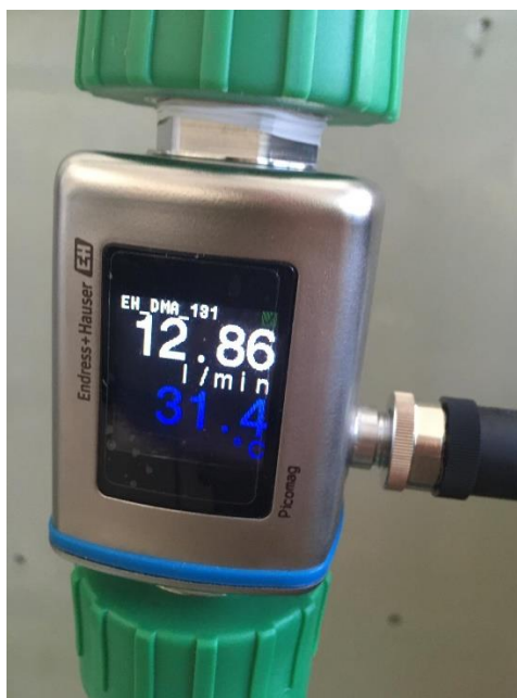
Slika 9. Elektromagnetski protokomjer Endress Hauser
