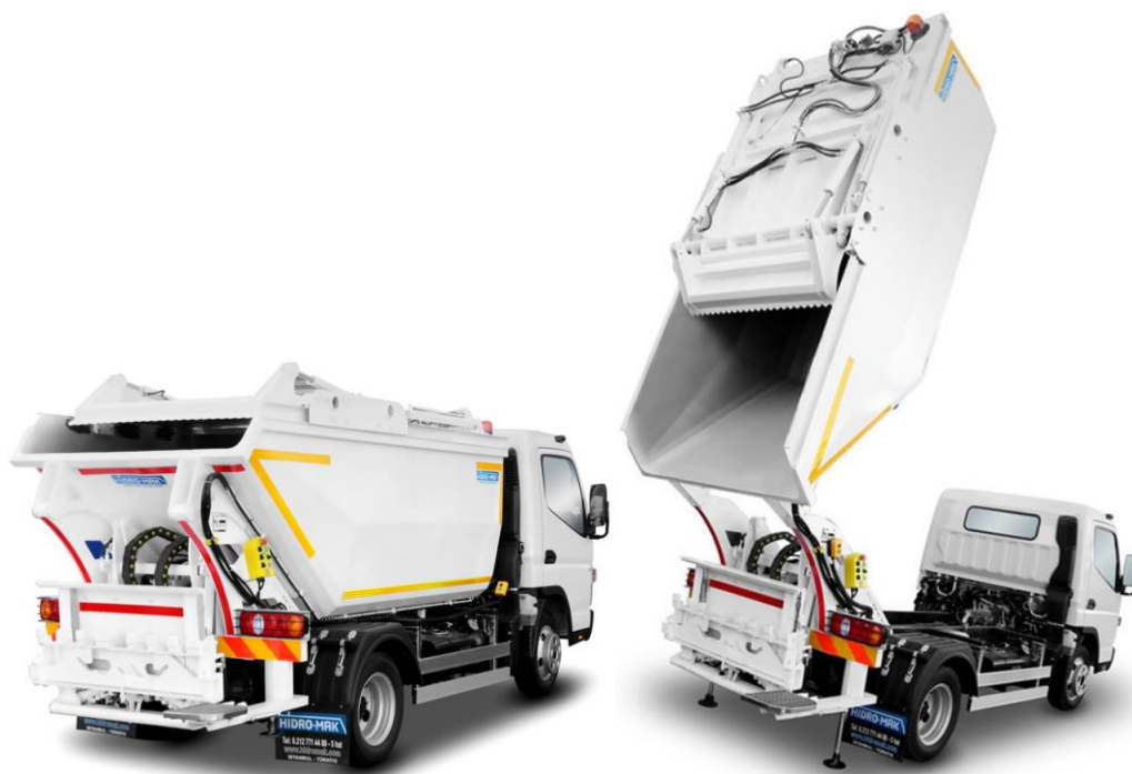
Slika 25. HIDRO – MAK MaXi Tipper u položaju spremnom za utovar i položaju za samoistovarivanje [31]
