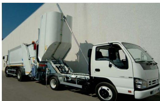
Slika 39. Način podizanja sanduka s jednim cilindrom pričvršćenim na prednjoj strani [34]
