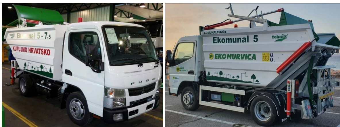
Slika 78. Koncept 1 sustava za sabijanje otpada [33]
