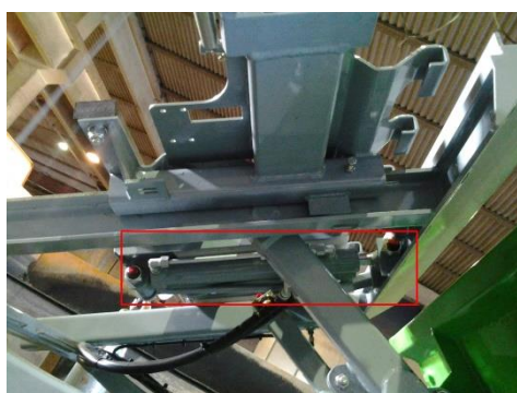
Slika 34. Izvedbe hidrauličkih cilindara za učvršćenje kanti: a) s jednim cilindrom [20] i b) s dva cilindra [38]
