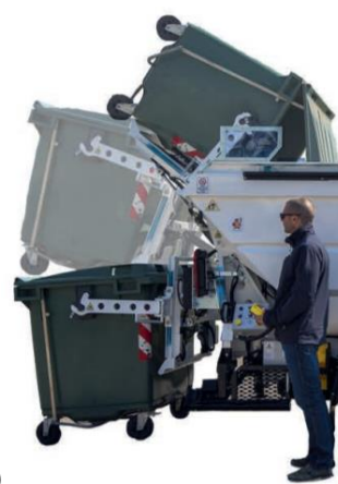
Slika 33. a) podizanje kanti pomoću zubi [37] i b) podizanje kontejnera pomoću ruku [36]
