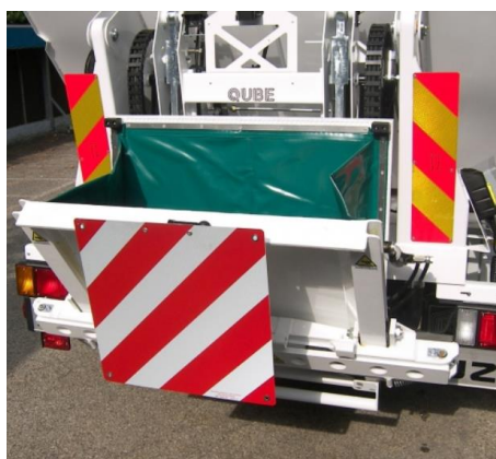
Slika 35. Džep za utovar vreća i sličnog otpada [36]
