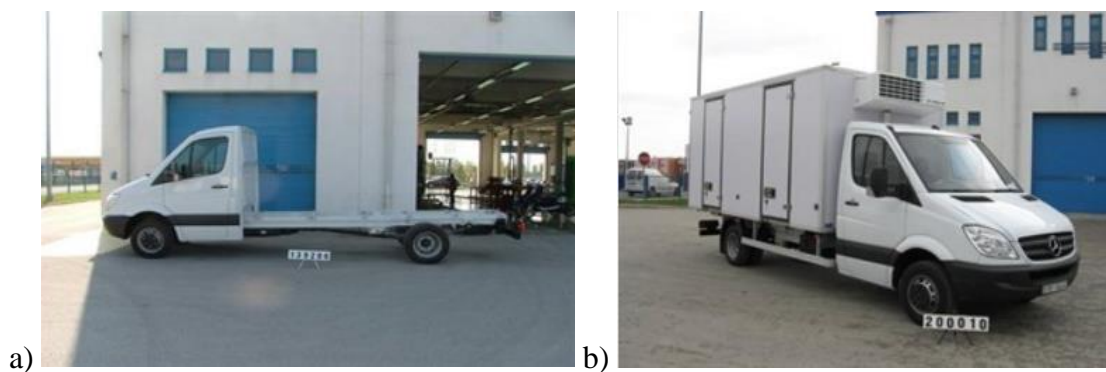
Slika 14. Višestupanjska homologacija: a) nepotpuno vozilo i b) dovršeno vozilo [24]
