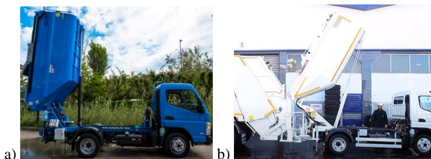
Slika 38. Način podizanja sanduka s prihvatom na stražnjoj strani: a) s jednim cilindrom [36] i b) s dva cilindra [31]
