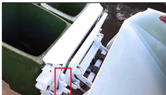
Slika 34. Izvedbe hidrauličkih cilindara za učvršćenje kanti: a) s jednim cilindrom [20] i b) s dva cilindra [38]
