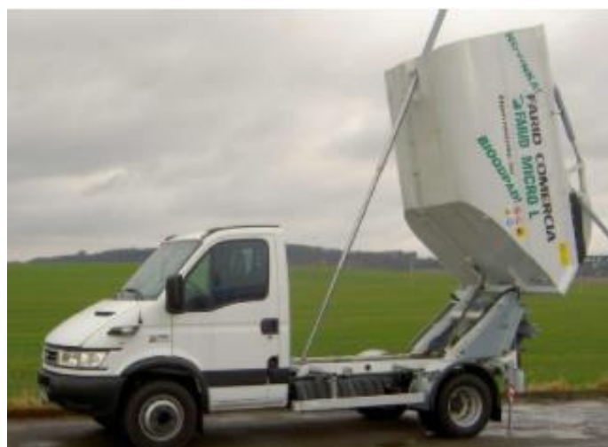
Slika 81. Koncept 2 sustava za samoistovarivanje sanduka [34]
