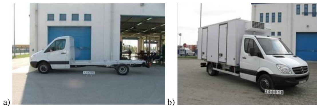
Slika 14. Višestupanjna homologacija: a) nepotpuno vozilo i b) dovršeno vozilo [24]
