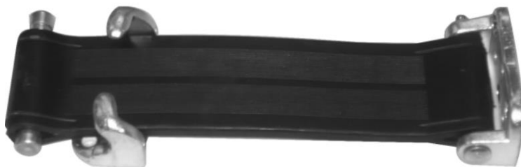
Slika 187. Mehanizam za držanje graničnika kanti i kontejnera u početnom položaju [63]
