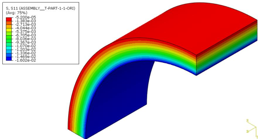
Slika 43. Raspodjela radijalnog naprezanja - HGO materijalni model
