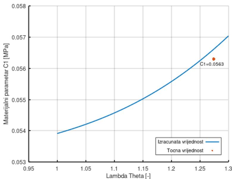
**Slika 28. Utjecaj promjene vrijednosti cirkularnog istezanja na materijalni parametar  $C_1$**
