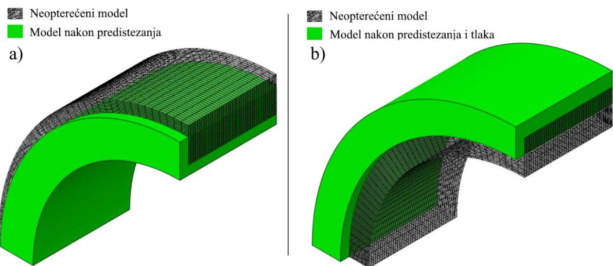
Slika 45. Holzapfel-Gasser-Ogden model bez opterećenja i nakon a) aksijalnog predistezanja b)
