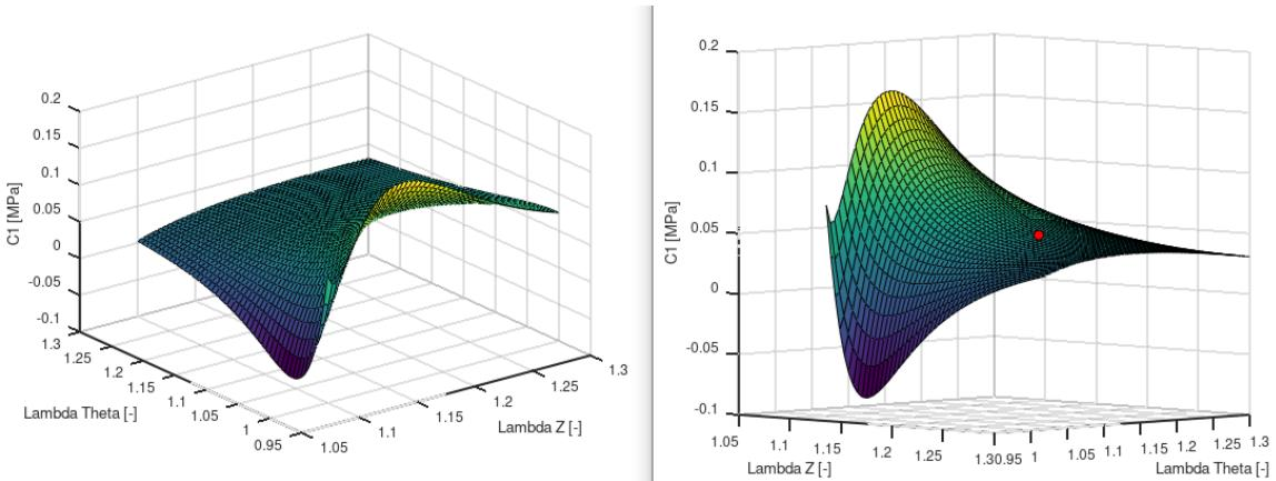
Slika 39. Utjecaj promjene vrijednosti  $\lambda_z$  i  $\lambda_\theta$  na materijalni parametar  $C_1$
