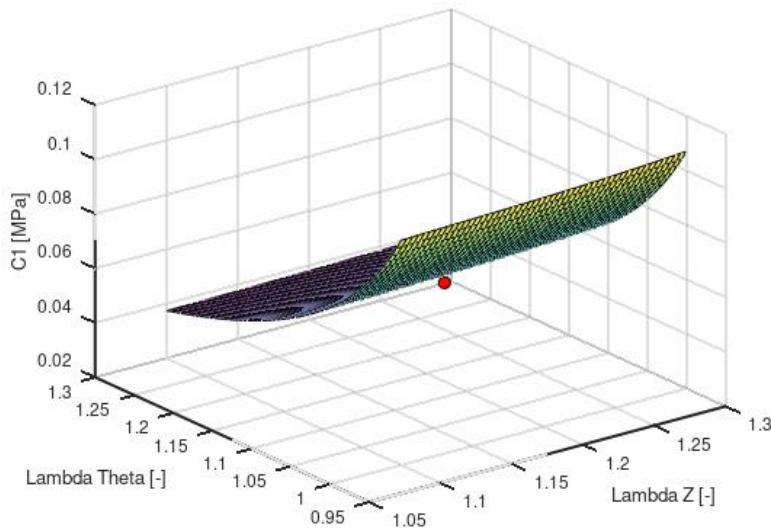
Slika 29. Utjecaj promjene vrijednosti  $\lambda_z$  i  $\lambda_\theta$  na materijalni parametar  $C_1$
