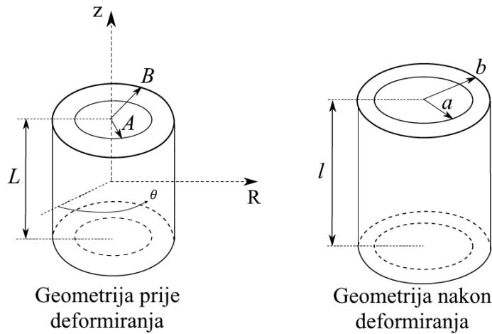
**Slika 6. Oznake geometrije u referentnoj i trenutnoj konfiguraciji**
