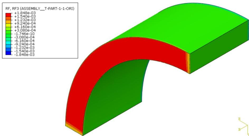
Slika 44. Rezultantna aksijalna sila - HGO materijalni model
