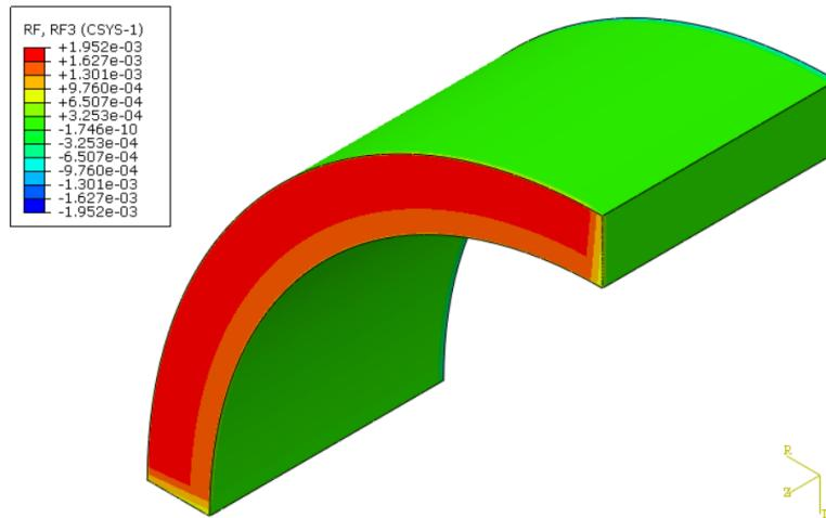
**Slika 25. Resultantna aksijalna sila - Neo-Hooke materijalni model**
