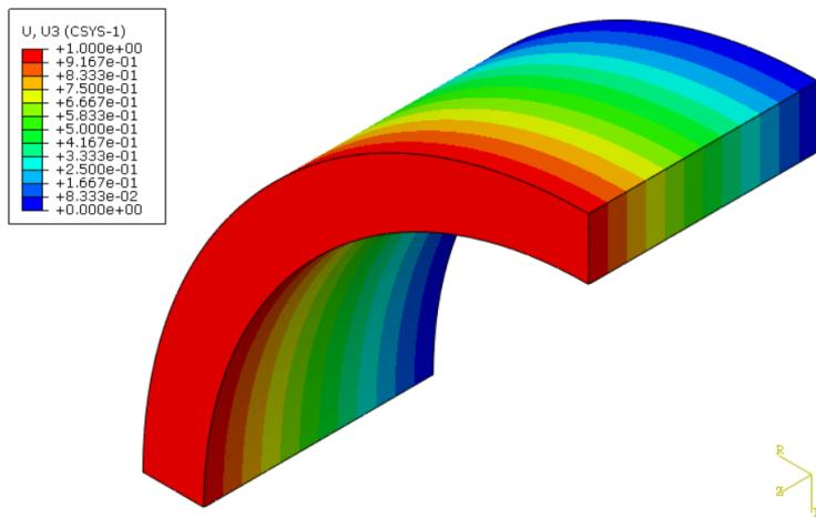
Slika 23. Pomak u aksijalnom smjeru - *Neo-Hooke* materijalni model
