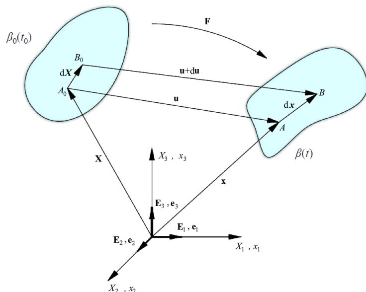
Slika 4. Deformiranje tijela iz referentne u trenutnu konfiguraciju [10]
