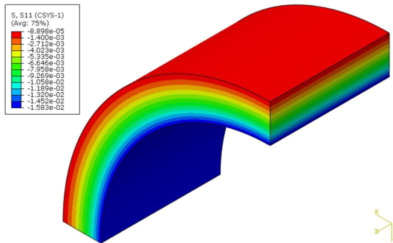
Slika 32. Raspodjela radijalnog naprezanja - *Mooney-Rivlin* materijalni model
