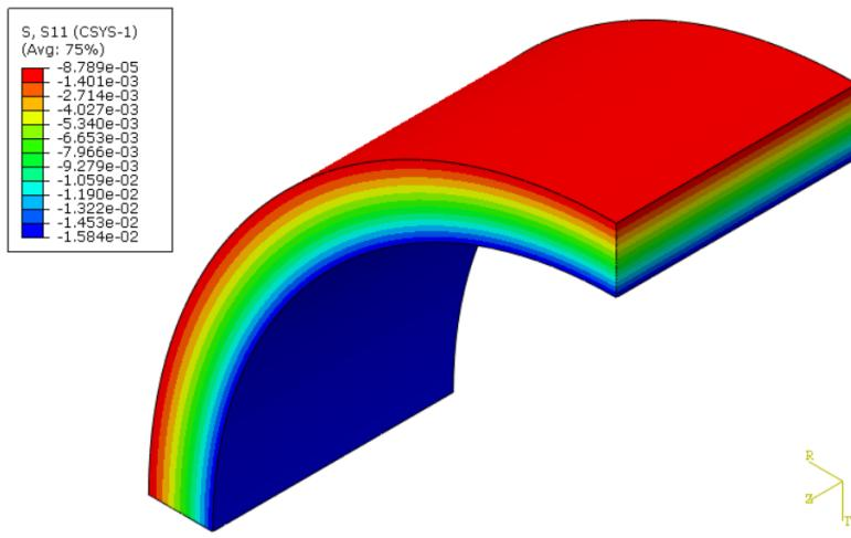
Slika 24. Raspodjela radijalnog naprezanja - *Neo-Hooke* materijalni model
