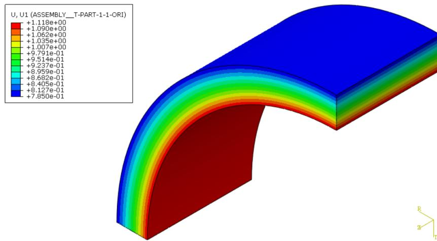
Slika 41. Pomak u radijalnom smjeru - *Holzapfel-Gasser-Ogden* materijalni model
