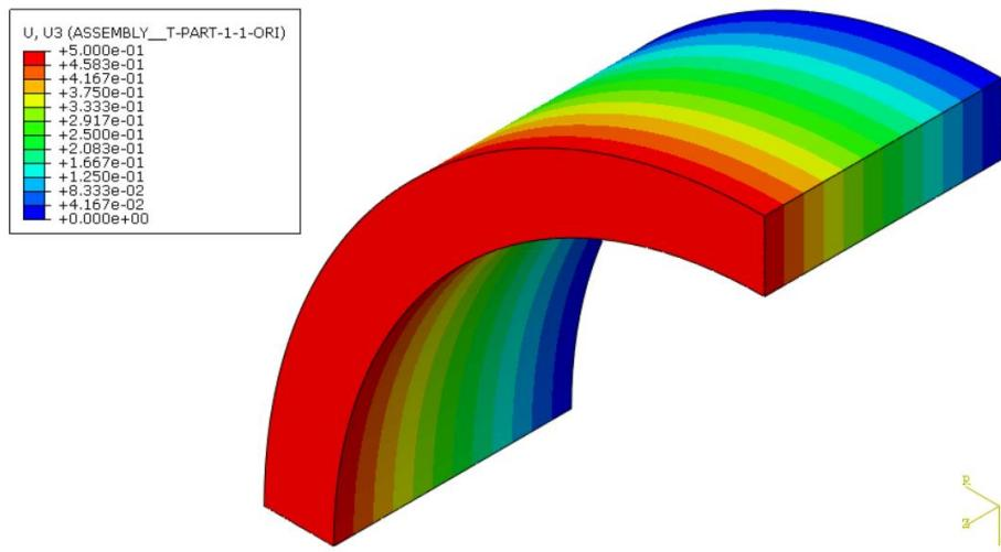
Slika 42. Pomak u aksijalnom smjeru - *HGO* materijalni model
