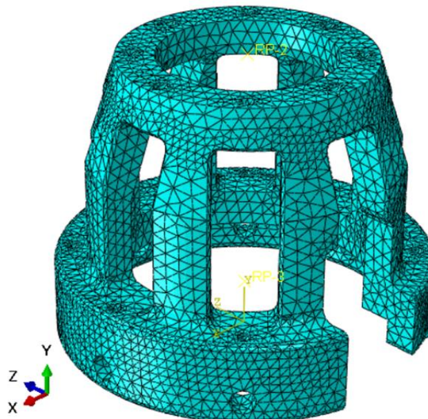
Slika 9.2 Konvergirana mreža konačnih elemenata gornjeg kućišta za slučaj kada je opterećeno vlačno
