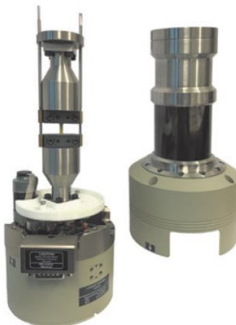
Slika 10.3 Kidalica DEBEN CT5000 sa skinutim gornjim kućištem [39]
