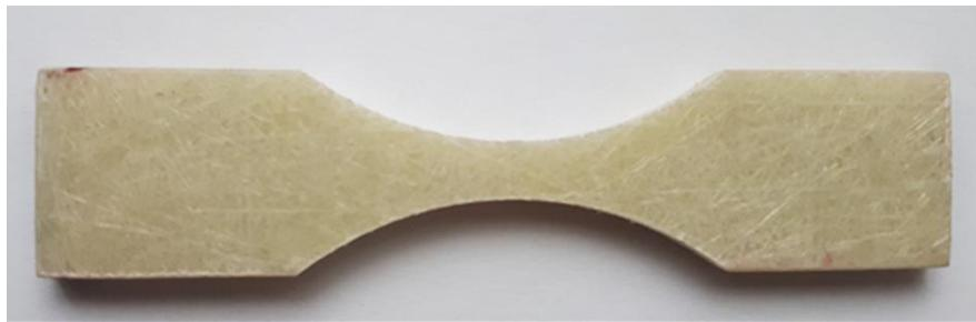
Slika 6.2 Primjer FRP uzorka za vlačni test
