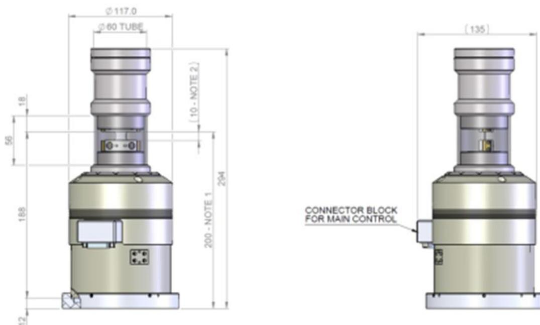
Slika 10.1 Vanjske dimenzije uređaja DEBEN CT5000 [38]
