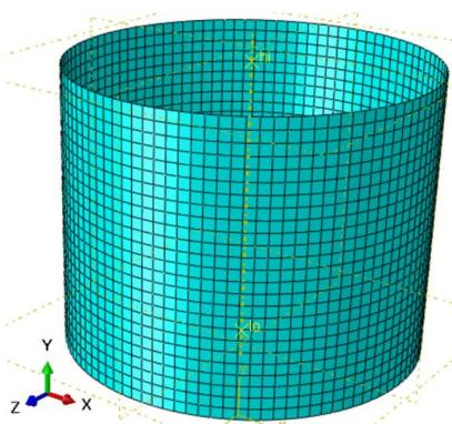
**Slika 9.11 Konvergirana mreža konačnih elemenata kod izvijanja cijevi**
