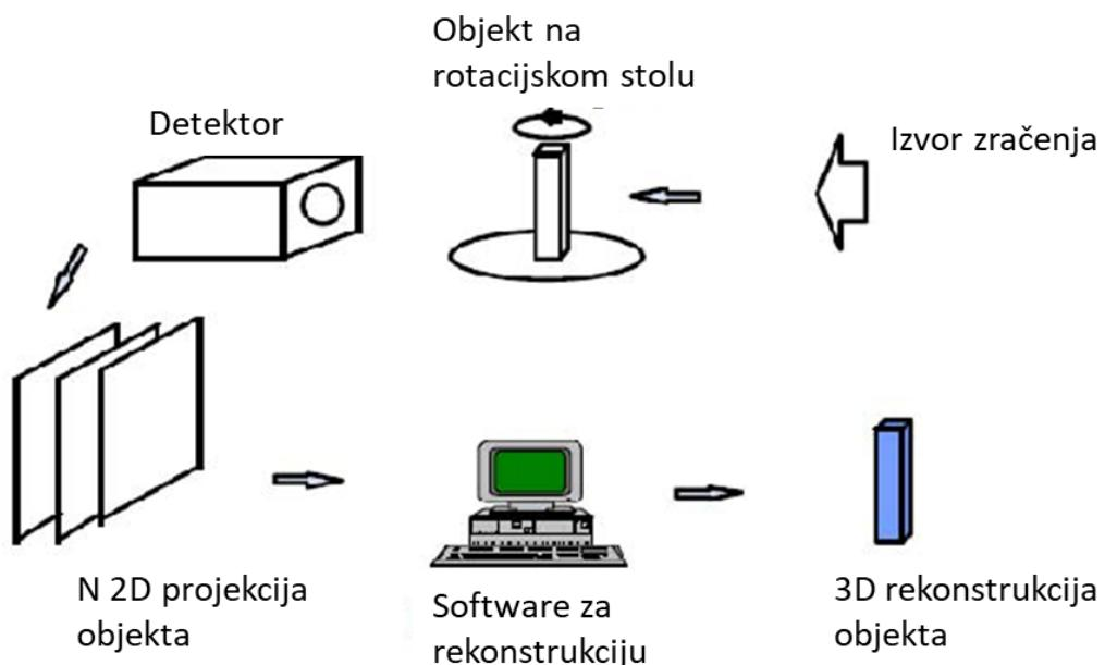
**Slika 2.3 Princip rada industrijskog CT uređaja [8]**
