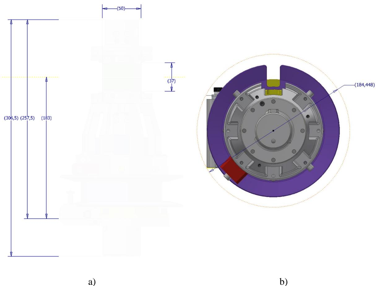
**Slika 7.12 Vanjske dimenzije modificirane kvazi-statičke in-situ kidalice u a) nacrtnom prikazu i b) tlocrtnom prikazu**
