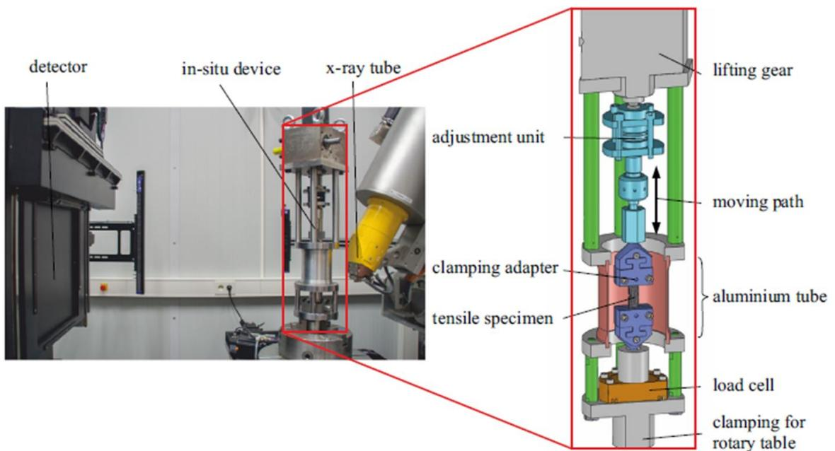
**Slika 3.4 In situ uređaj za vlačni test [3]**
