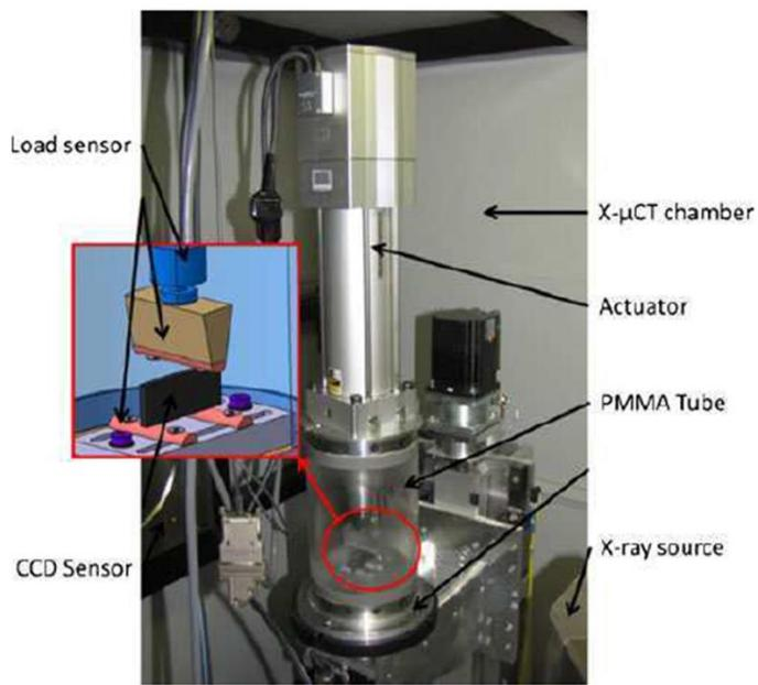
**Slika 3.3 In-situ uređaj za ispitivanje kompozitnih laminata [15]**
