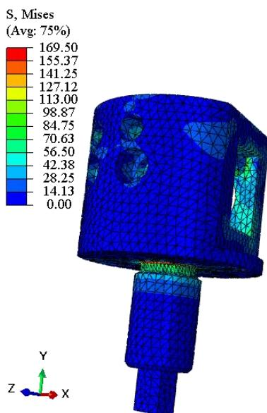
**Slika 9.9 Polje naprezanja na konvergiranoj mreži kućišta čeljusti**
