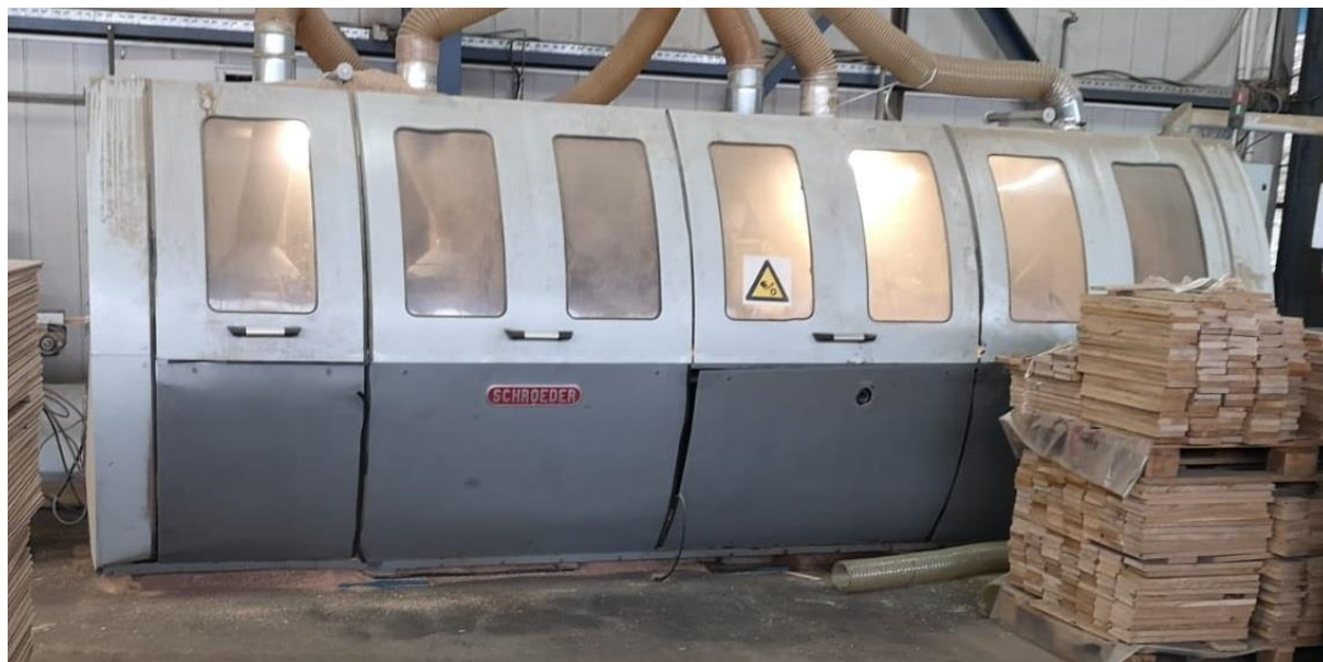
Slika 12. Stroj za izradu uzdužnih utora
