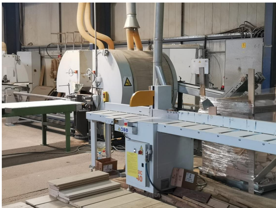
Slika 13. Stroj za izradu poprečnih utora sa konvejerom i stroj za rezanje
