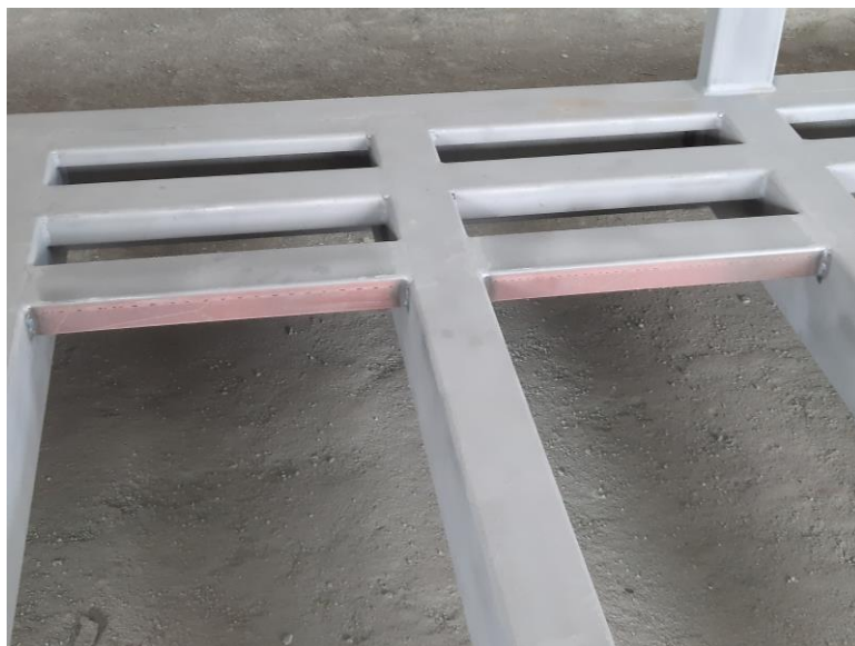
Slika 12. Neočišćena površina od prskotina
