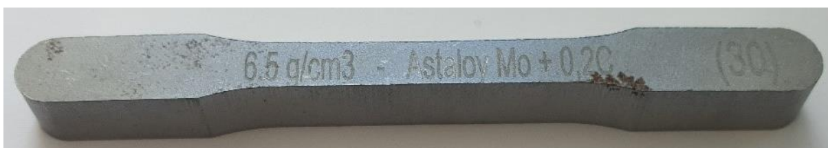
Slika 5.1 – Epruveta od sinteriranog čelika Astaloy Mo+0,2C gustoće 6,5 \text{ g/cm}^3 na kojoj je izvršena metalografska analiza
