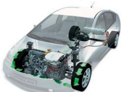
**Slika 2.3.** Pogonska osnova Toyote Prius - elektromotor i benzinski motor kod Priusa su smješteni poprečno naprijed
