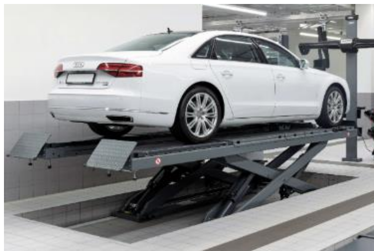
Slika 7. Ugradnja u podu [4]
