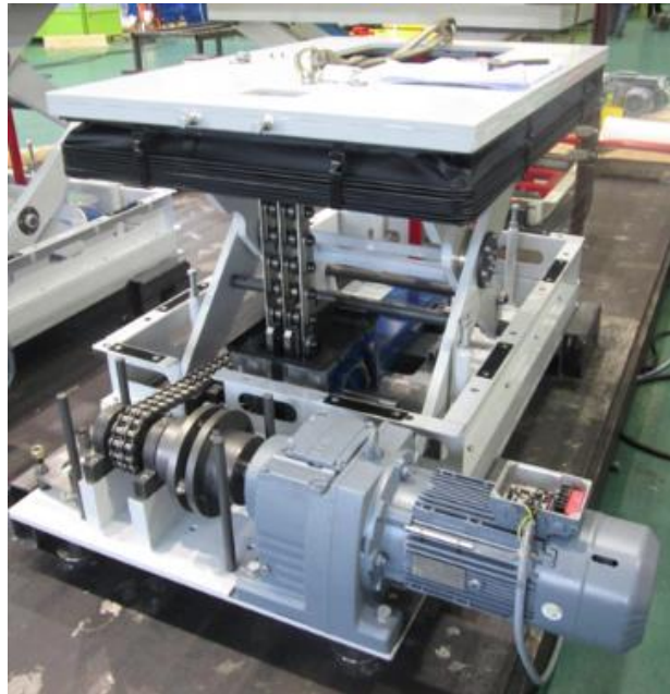
Slika 30. Škarasti mehanizam s lančanim stupom [14]
