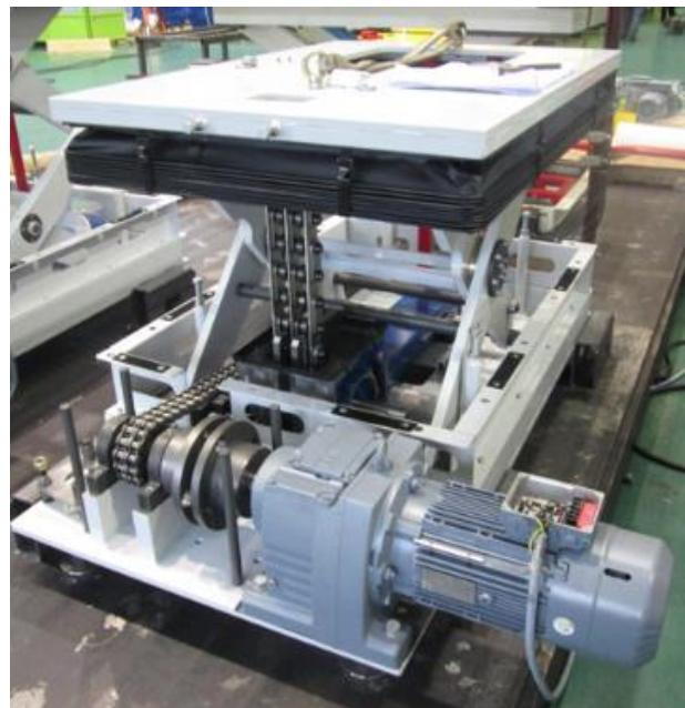
**Slika 30. Škarasti mehanizam s lančanim stupom [14]**
