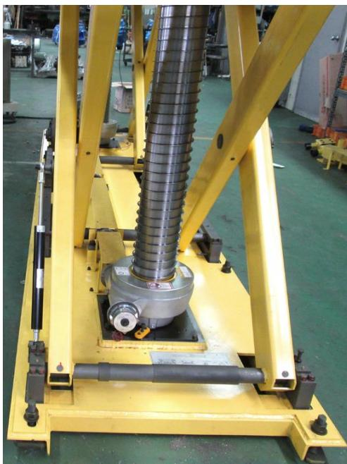
**Slika 29.** Škarasti mehanizam sa spiralnim vođenjem [13]
