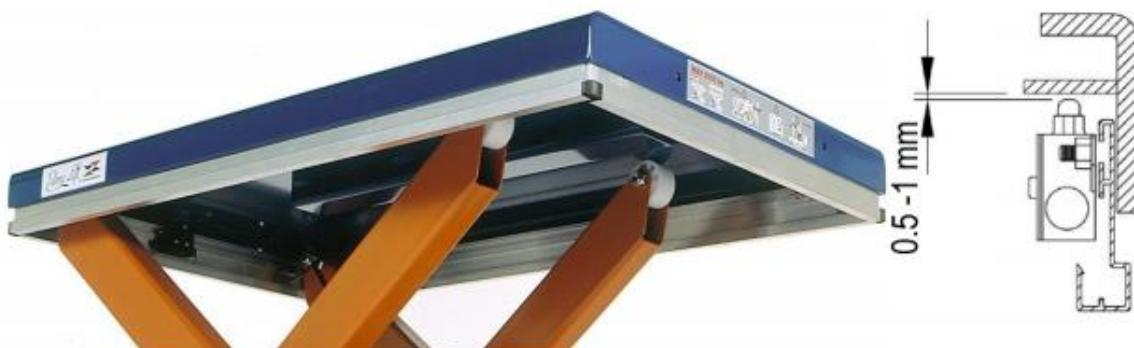
Slika 15. Sigurnosni okvir i način ugradnje mikroprekidača [2]
