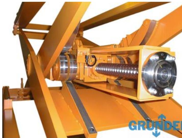
**Slika 27.** Podizni mehanizam s navojnim vretenom [12]
