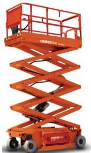
Slika 12. Višestruki škarasti mehanizam [6]
