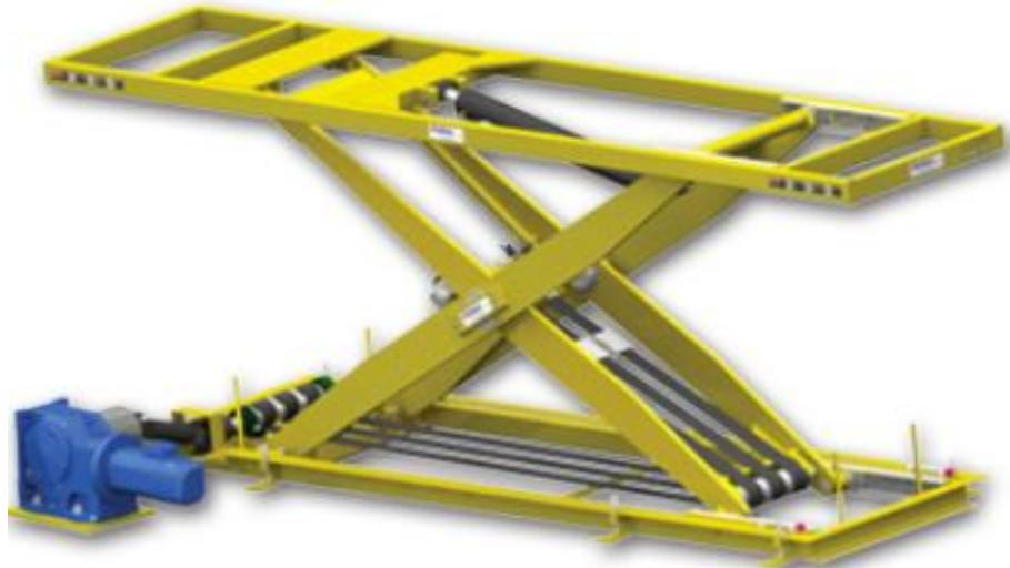
**Slika 31. Škarasti mehanizam s remenskim prijenosom [15]**
