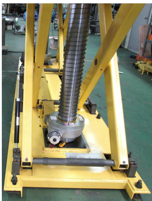
Slika 29. Škarasti mehanizam sa spiralnim vođenjem [13]
