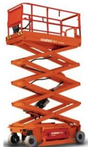
Slika 12. Višestruki škarasti mehanizam [6]
