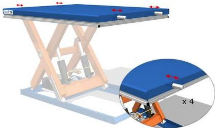
**Slika 23. Zaključavanje platforme podizača [9]**
