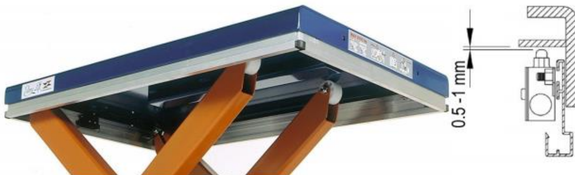
Slika 15. Sigurnosni okvir i način ugradnje mikroprekidača [2]
