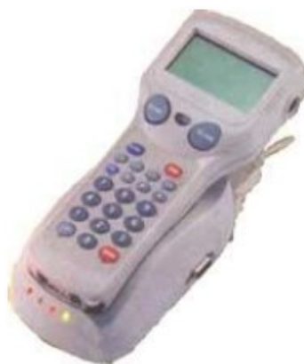
Slika 3. RF ručni čitač [1]
