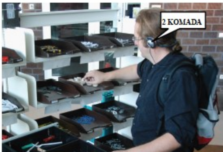
Slika 35. Glasom usmjereno komisioniranje [11]
