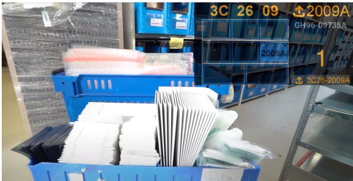
Slika 44. Vizijsko komisioniranje u Samsungu [20]
