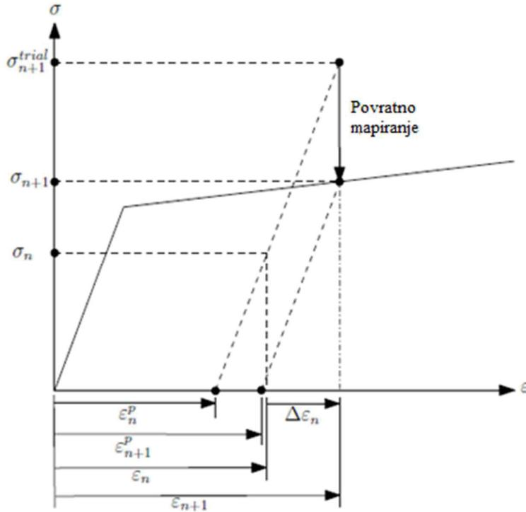
Slika 11. Povratno preslikavanje iz pokusnog elastičnog stanja
