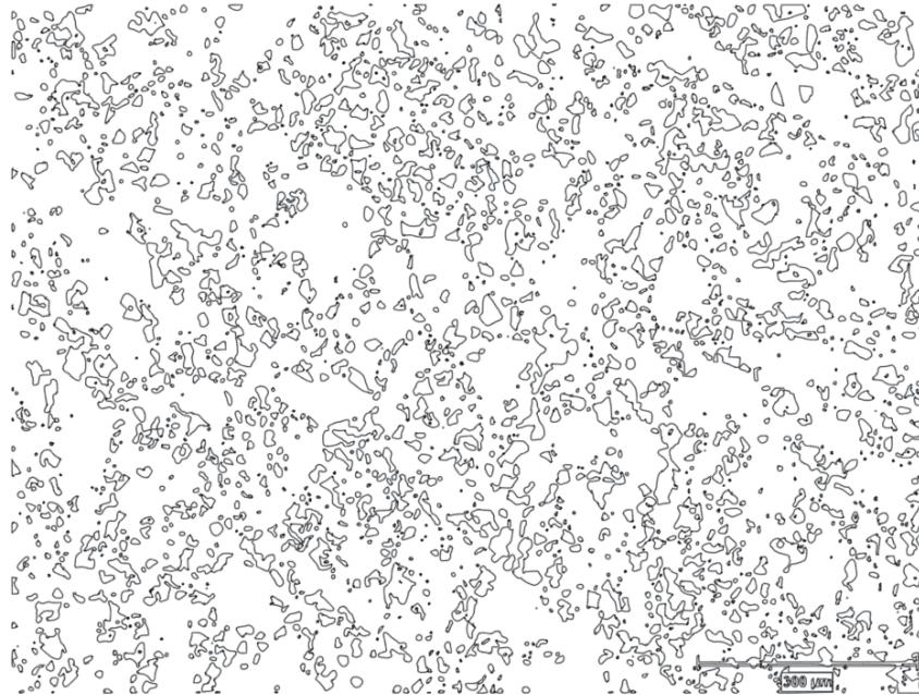
Slika 18. Mikrostruktura sinteriranog čelika Astaloy Mo+0,2C nakon obrade u programskom paketu *QCAD*
