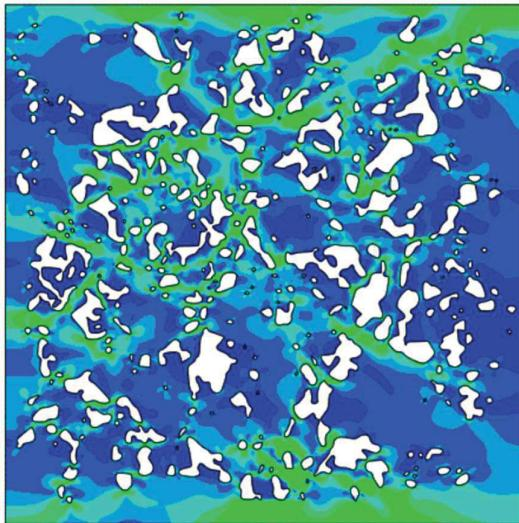
Slika 23. Von Misesovo naprezanje za RVE 3
