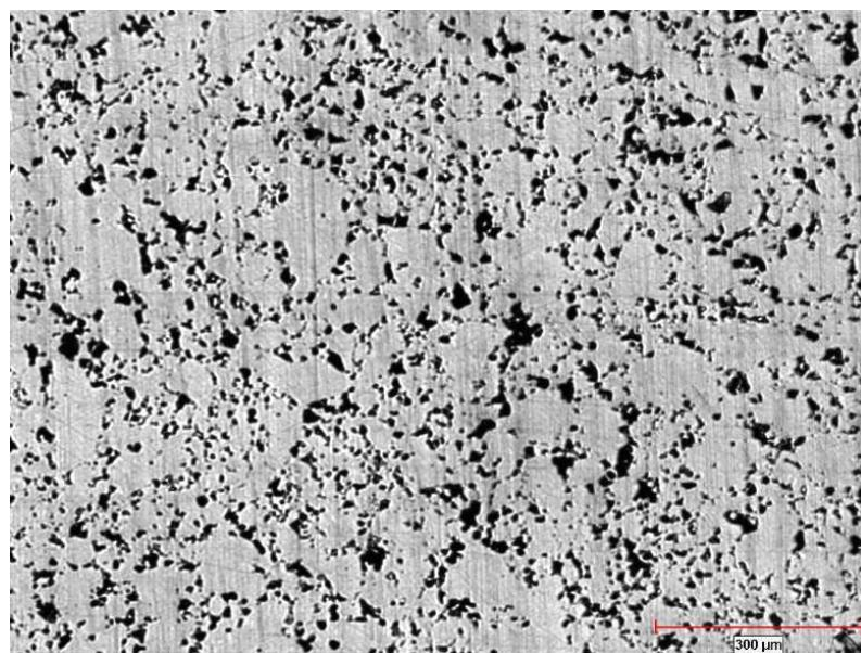
Slika 17. Mikroskopska snimka sinteriranog čelika Astaloy Mo+0,2C ( $\rho=6,8 \text{ g/cm}^3$ )
