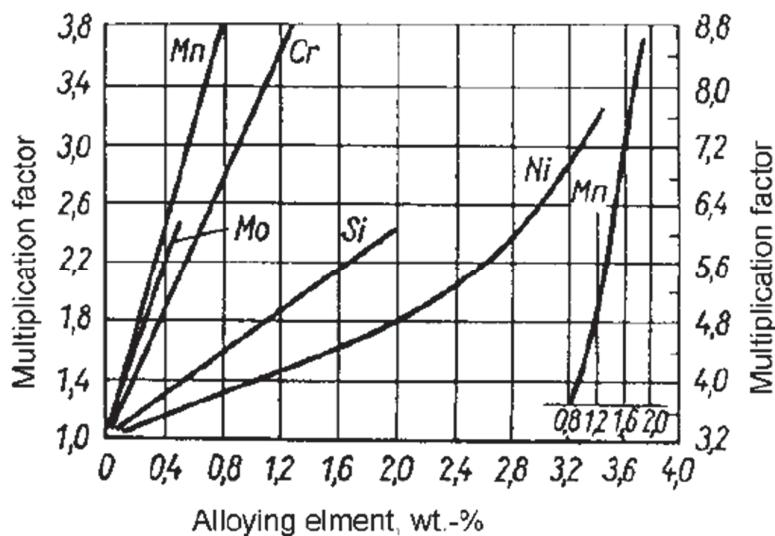
Slika 4. Legirajući elementi u sinteriranom čeliku [2]
