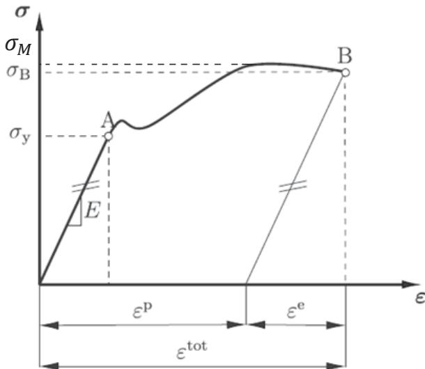
Slika 10. Dijagram ovisnosti naprezanja i deformacija [4]
