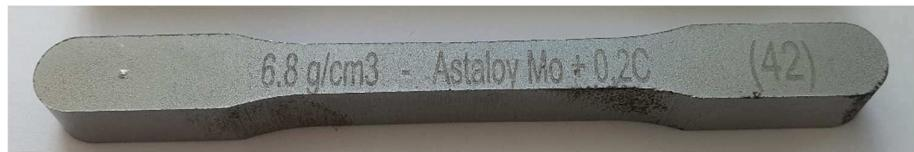
Slika 16. Uzorak epruvete Astaloy Mo+0,2C ( $g=6,8 \text{ g/cm}^3$ )
