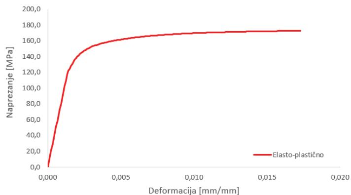
**Slika 33. Dijagram von Misesovo naprezanje-deformacija za elasto-plastično ponašanje Astaloy Mo+0,2C ( $g=6,25$  g/cm<sup>3</sup>)**
