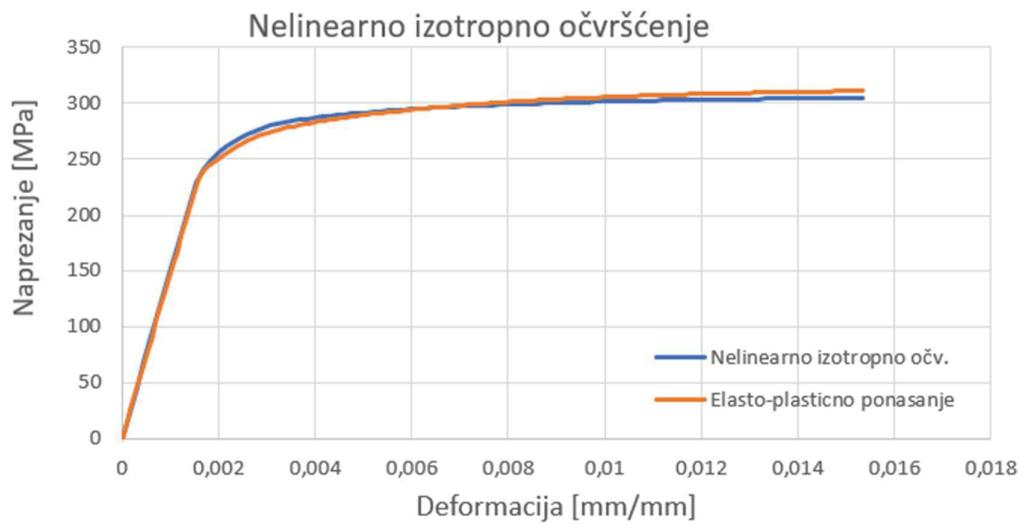
**Slika 30. Dijagram von Misesovo naprezanje-deformacija za pristup nelinearnog izotropnog očvršćenja na makro razini**
