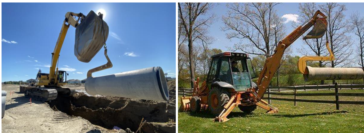
Slika 16. Primjeri korištenja samobalansirajuće kuke Kenco [12]
