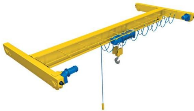
Slika 2. Mosni granik s jednim glavnim nosačem [5]
